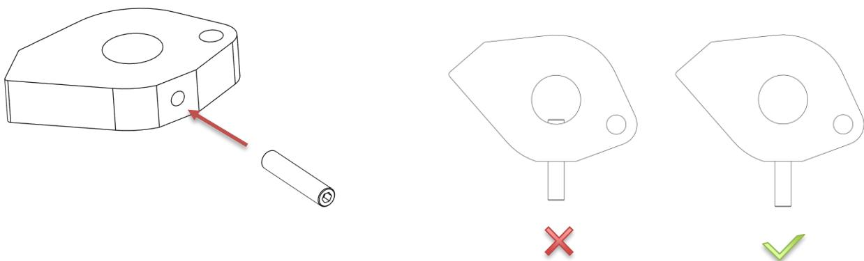
Placez l'arbre à cames verticalement, le trou oblong vers le haut. Faites glisser le bloc d' entraînement sur l'arbre à cames. Déplacez légèrement le bloc d' entraînement vers le bas jusqu'à ce que la vis de réglage s'aligne avec le **trou oblong** dans le tube. Vissez la vis de réglage.
