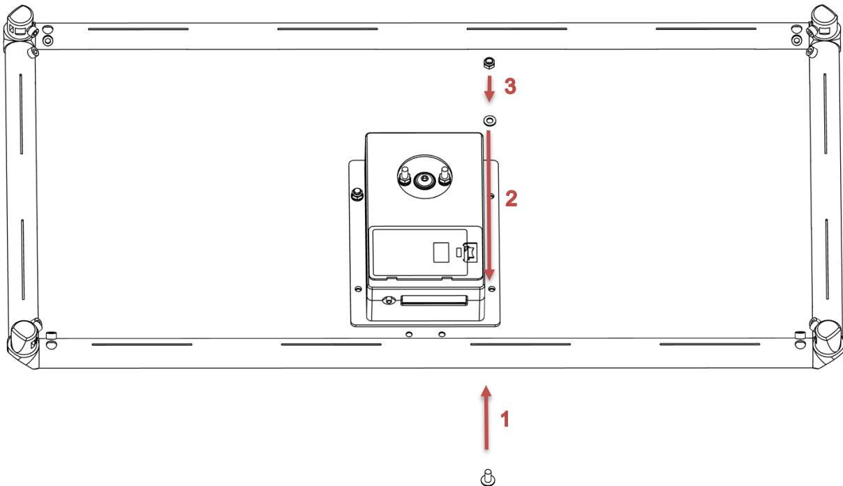
Insérez **deux boulons à tête bombée de 14 mm de longueur** à partir de l'arrière de la plaque en aluminium à travers la base du contrôleur. Placez une rondelle sur le boulon et posez **un écrou de blocage**. Serrez les écrous de blocage à la main jusqu'à ce que vous sentiez une résistance.
