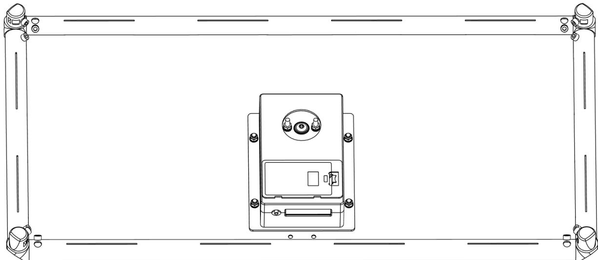
Prenez la butée de porte en plastique. Insérez **deux écrous** dans la butée de porte de la même manière que pour les pièces d'angle. Appuyez sur les écrous jusqu'à ce que les trous s'alignent.
