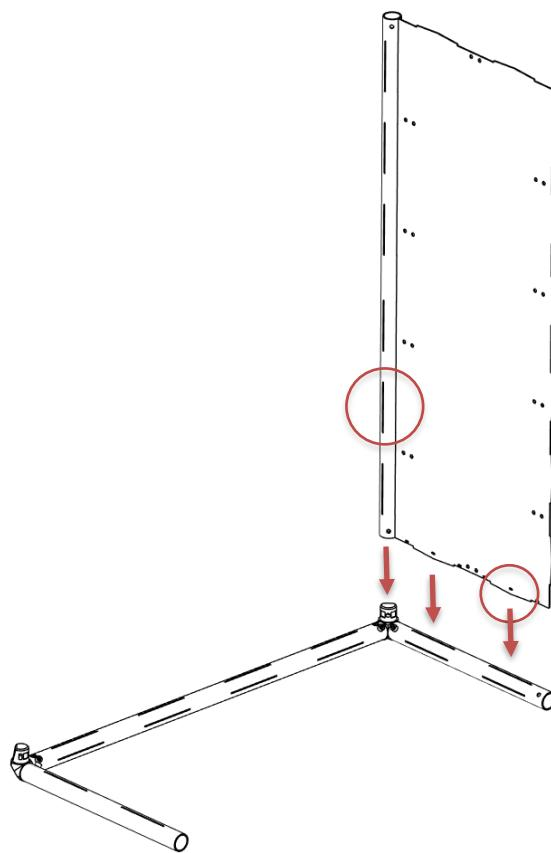
Insérez un **boulon Allen de 20 mm de long** et vissez-le légèrement.
