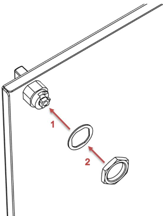
Assurez-vous que le bouton est orienté vers le bas et positionnez la languette de verrouillage de manière à ce qu'elle soit orientée **vers le haut**. Insérez le boulon et serrez fermement à l'aide d'une **clé à anneau de 10 mm**.
