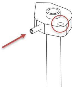
Placez le bloc d' entraînement de manière à ce que la vis de réglage se trouve **à peu près au milieu du trou oblong**. Il s'agit de la position neutre qui fonctionne correctement dans la plupart des cas. Serrez la vis de réglage jusqu'à ce qu'elle serre presque le bloc d' entraînement sur l'arbre à cames. L'arbre à cames doit pouvoir tourner sans effort. Le serrage définitif sera effectué plus tard lors du réglage fin de l'arbre à cames.
