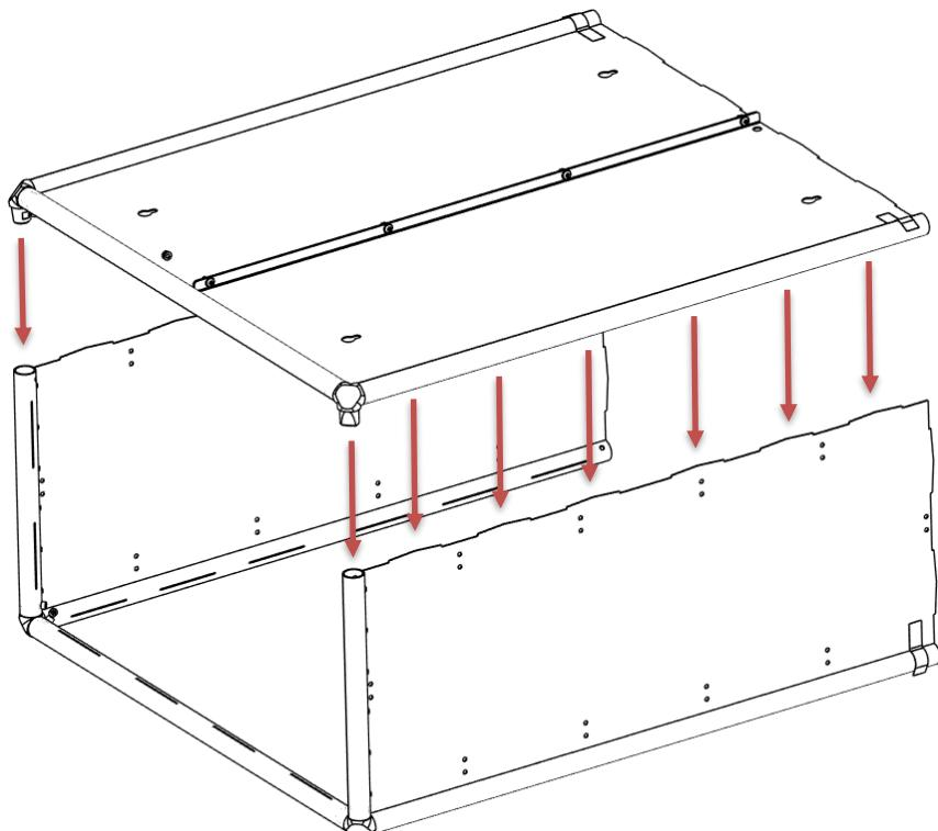
Insérez **deux boulons Allen de 20 mm de long** et vissez-les légèrement. Fixez les extrémités des tubes longs aux panneaux latéraux à l'aide de ruban adhésif.
