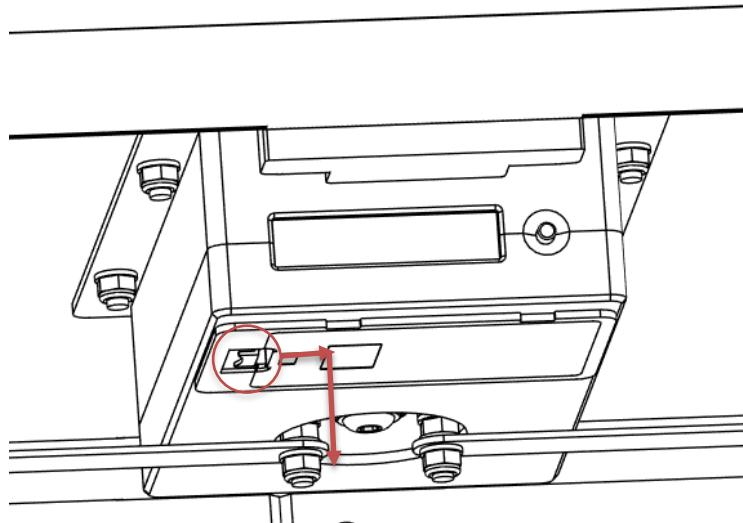
Insérez **six piles AA** dans le compartiment à piles. Types de piles autorisés :
