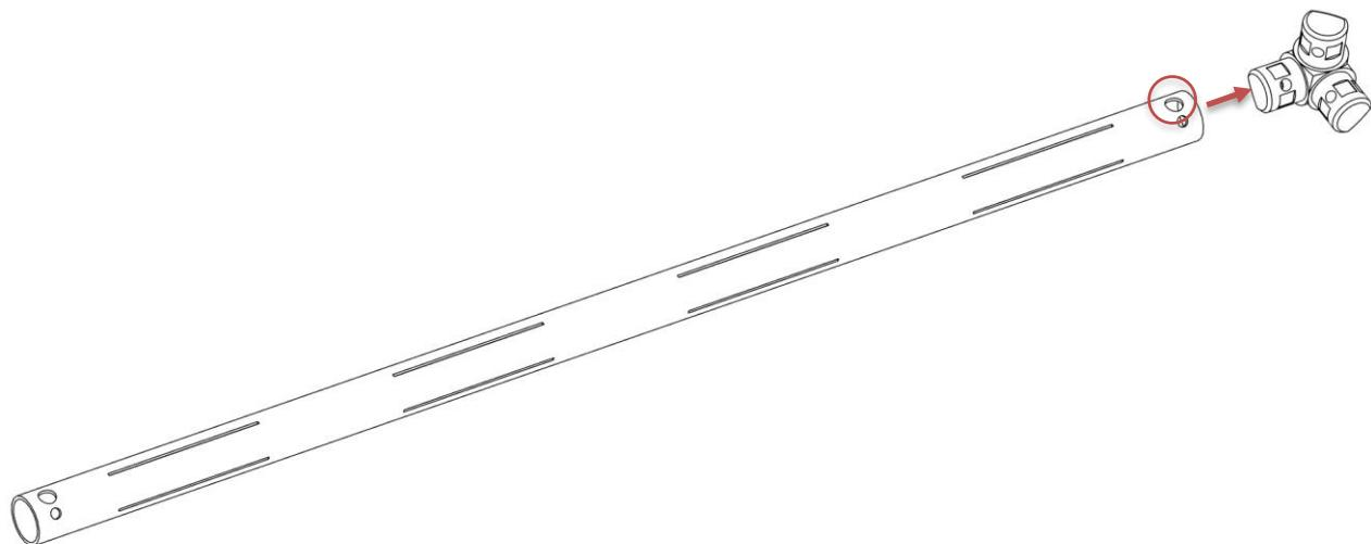
**ATTENTION :** Vérifiez bien l'orientation du grand trou. Ce trou sera utilisé plus tard pour la charnière de la porte. Une orientation incorrecte empêchera l'installation de la porte.
