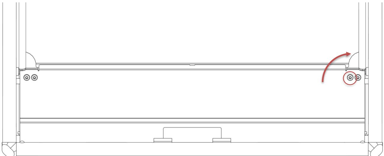
Si le deuxième écrou a été retiré précédemment, réinsérez-le maintenant. Maintenez l'écrou en place avec un doigt et insérez un **boulon à tête bombée de 14 mm de long** dans la charnière à travers la trappe. Vissez le boulon et serrez-le fermement à l'aide d'une clé Allen.
