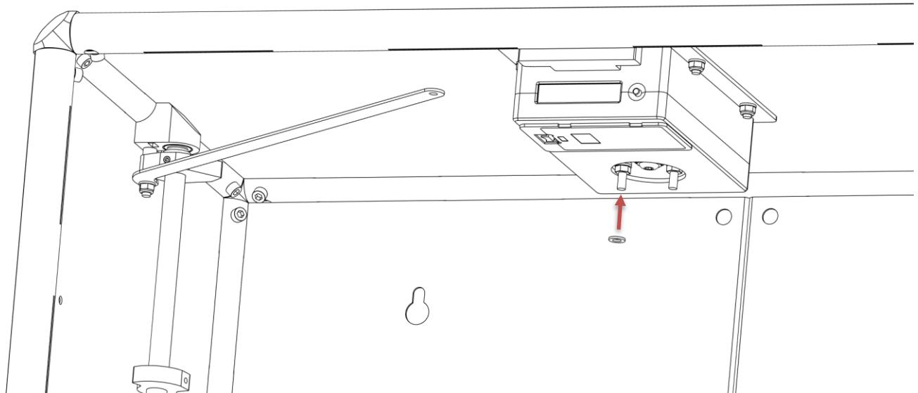
Tirez légèrement la plaque de liaison vers le bas et placez-la sur le boulon gauche du contrôleur. Ajoutez une deuxième rondelle et vissez un **écrou de blocage** (avec insert en nylon bleu).
