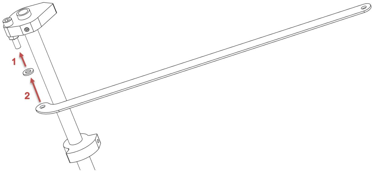
Placez une deuxième rondelle sur le boulon. Vissez un **contre-écrou** (avec insert en nylon bleu). Serrez le contre-écrou jusqu'à ce que vous sentiez une résistance, puis desserrez-le d'environ **1/8 de tour**. La plaque de liaison doit tourner librement avec un jeu axial minimal.
