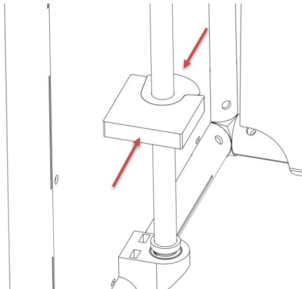
Serrez maintenant fermement la vis de fixation dans le bloc d'entraînement.
