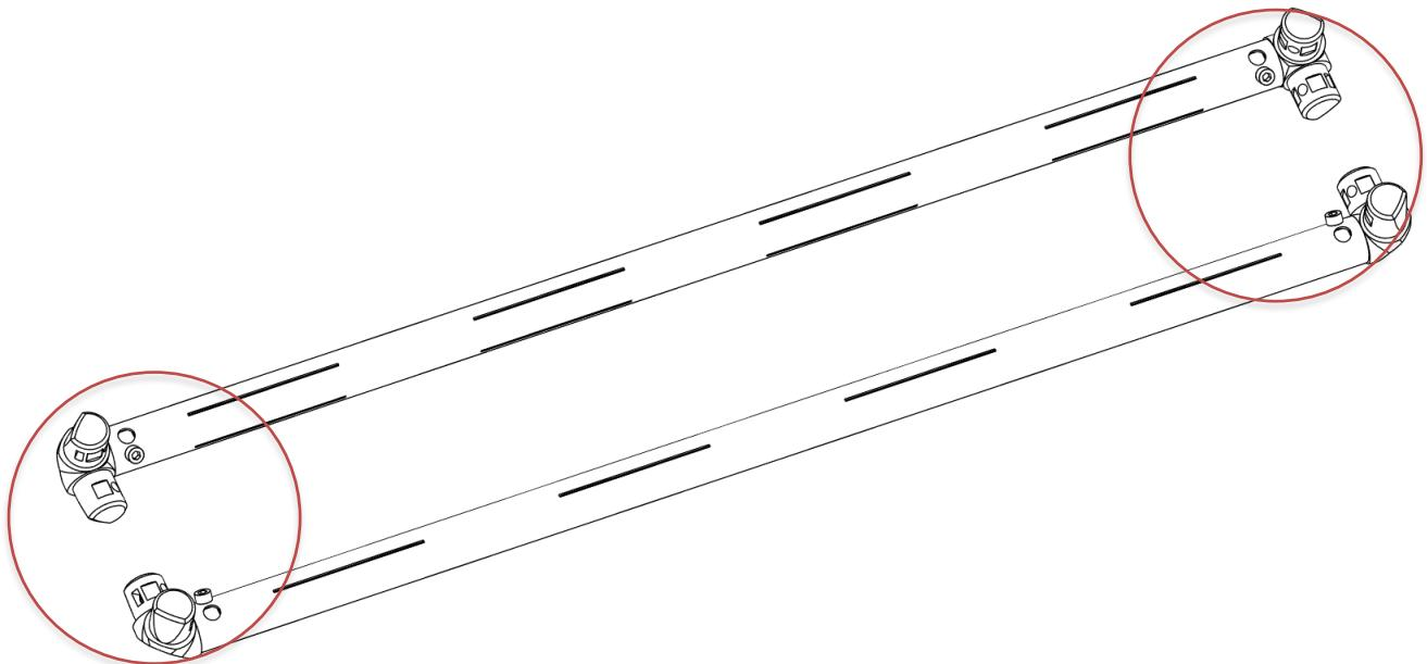
**ATTENTION :** Lorsque les deux tubes sont placés l'un en face de l'autre, les fentes horizontales doivent être tournées **l'une vers l'autre**.
