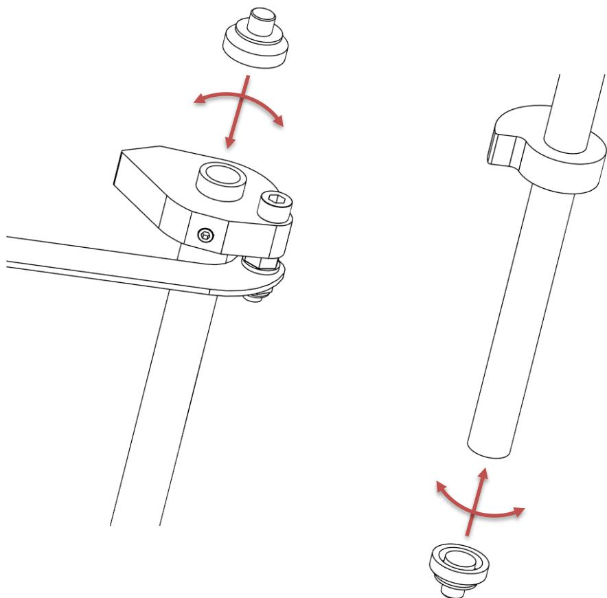
**Les deux arbres à cames** sont maintenant entièrement assemblés et prêts à être installés dans l'armoire.
