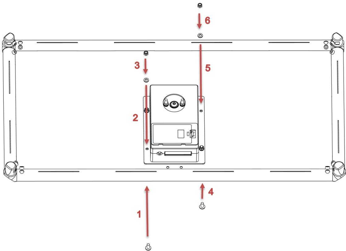
Serrez tous les écrous à l'aide d'une clé Allen et d'une **clé plate de 10 mm**.
