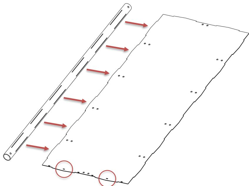
Faites glisser le tube et la feuille sur le tenon vertical de la pièce d'angle droite. Guidez les languettes de la feuille dans les fentes du tube court.
