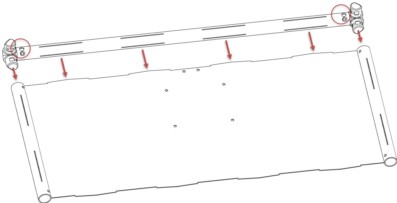
Insérez un **boulon Allen de 20 mm de long** dans chaque pièce d'angle à travers le tube et vissez-les légèrement.
