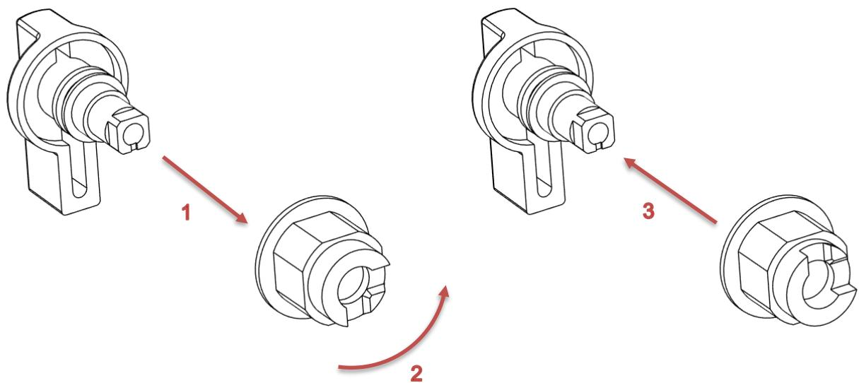
Insérez le bouton et le corps de serrure dans le trou octogonal.
