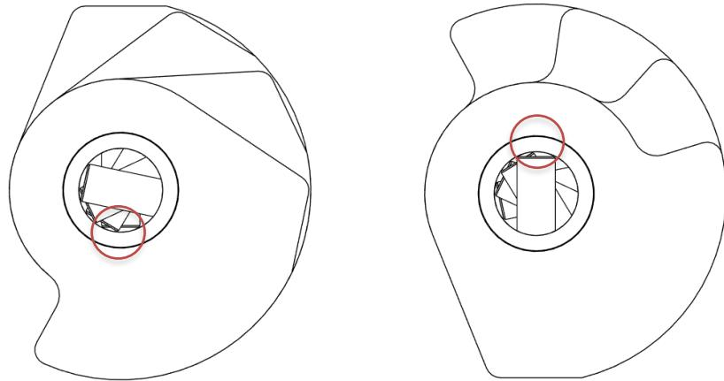
**ATTENTION :** Vérifiez trois fois cette orientation. Si les cames sont mal installées, les trappes ne fonctionneront pas correctement et l'arbre à cames devra être reconstruit.
