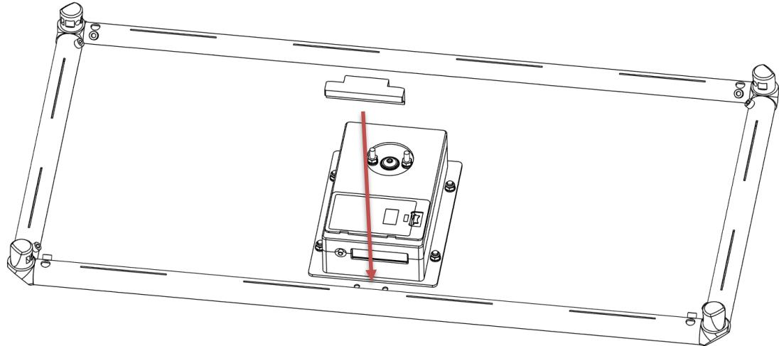
Insérez **deux boulons à tête bombée de 14 mm de longueur** à l'arrière de la feuille d'aluminium et serrez fermement.
