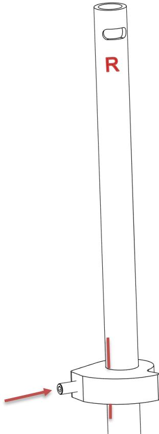
Vissez la vis de réglage vers l'intérieur. Si vous sentez une résistance avant que la vis de réglage ne soit complètement enfoncee :
