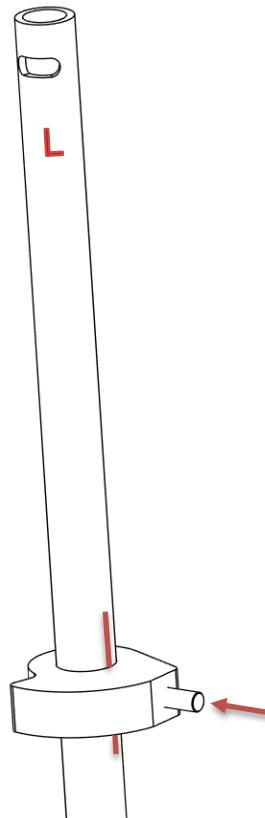
Vissez la vis de réglage vers l'intérieur. Si vous sentez une résistance avant que la vis de réglage ne soit complètement enfoncee :
