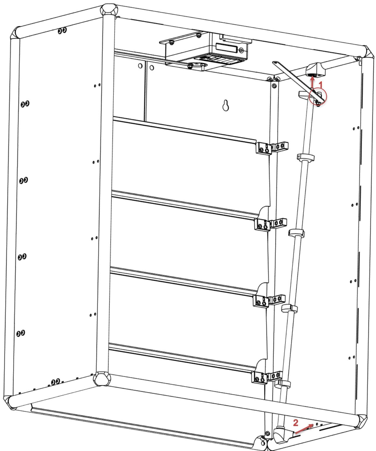
Fixez le bloc de palier inférieur à l'aide de **deux boulons à tête bombée de 14 mm de longueur**.
