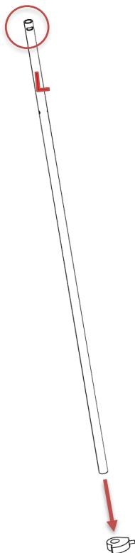
Faites glisser le bloc à came vers le haut jusqu'à ce qu'il atteigne le **trou marqué en haut**. Alignez la vis de réglage avec le trou marqué dans le tube en acier inoxydable.
