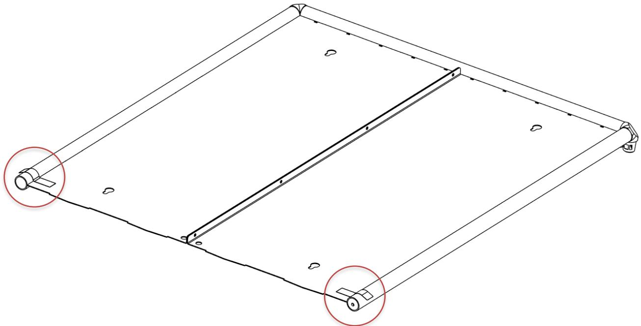
Insérez **quatre boulons à tête bombée de 14 mm de longueur** dans les trous des brides courtes des panneaux arrière. Ajoutez une rondelle et un écrou à chaque boulon. Alignez précisément les bords des deux brides.
