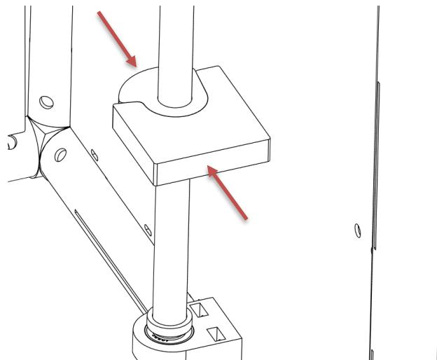
Serrez maintenant fermement la vis de fixation dans le bloc d'entraînement.
