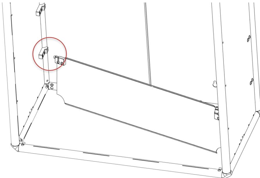
Déplacez le côté droit de la trappe près de la charnière droite de l'armoire. Tournez la charnière de la trappe **dans le sens des aiguilles d'une montre** jusqu'à ce qu'elle s'enclenche dans la charnière de l'armoire et que le trou derrière l'écrou inutilisé s'aligne avec le trou dans la trappe.
