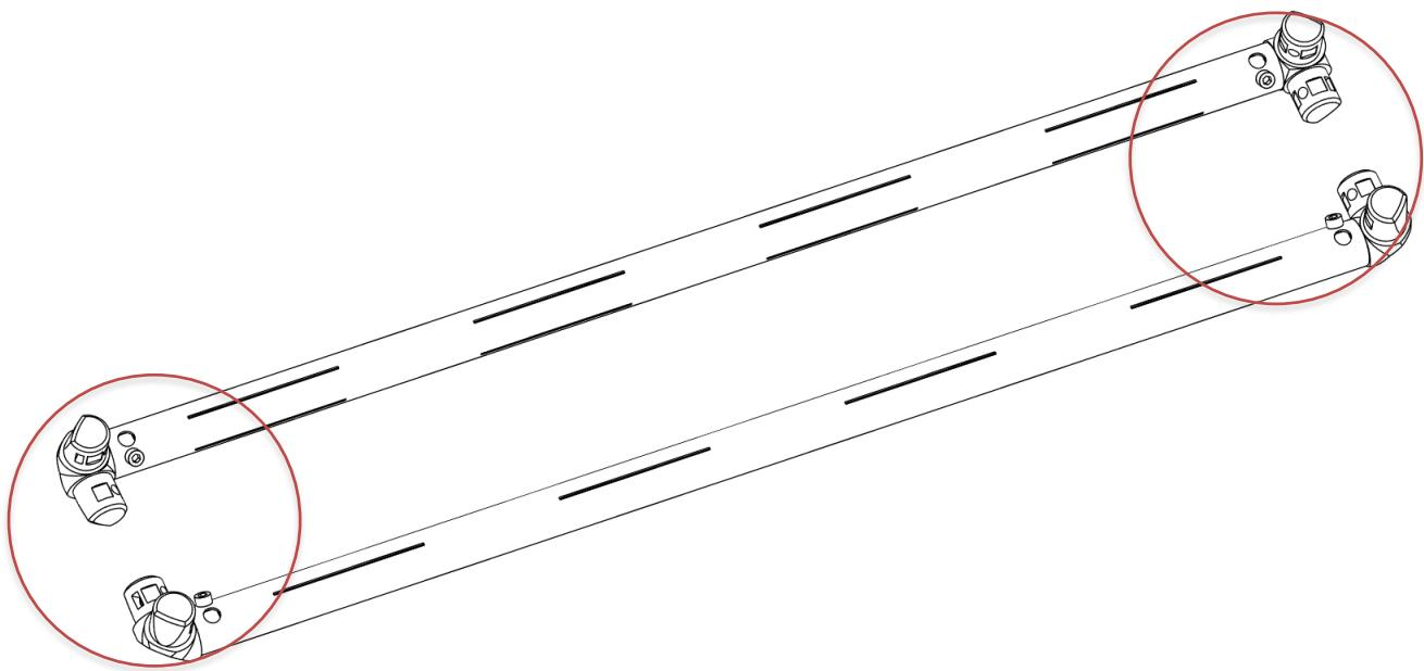
**ATTENTION :** Lorsque les deux tubes sont placés l'un en face de l'autre, les fentes horizontales doivent être orientées **l'une vers l'autre**.
