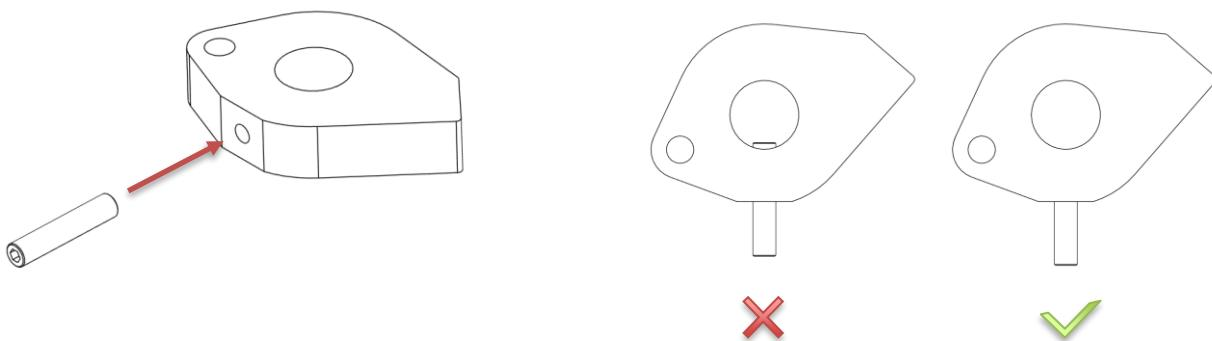
Placez l'arbre à cames verticalement, le trou oblong vers le haut. Faites glisser le bloc d' entraînement sur l'arbre à cames, en alignant la vis de réglage avec le trou oblong. Vissez la vis de réglage.
