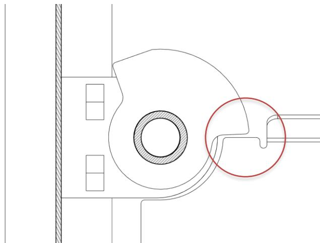
Si la trappe ne s'ouvre pas correctement, l'arbre à cames doit être réglé. Desserrez le boulon de fixation dans le bloc d'entraînement de deux tours dans le sens inverse des aiguilles d'une montre. Tournez ensuite l'arbre à cames jusqu'à ce qu'il corresponde à l'illustration ci-dessus. Resserrez ensuite fermement le boulon de fixation.
