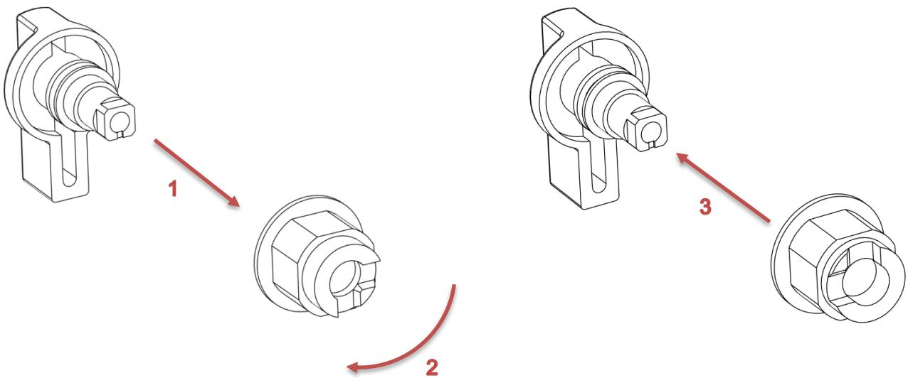
Insérez le bouton et le corps de serrure dans le trou octogonal.
