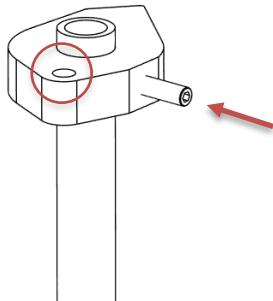
Placez le bloc d' entraînement de manière à ce que la vis de réglage se trouve **à peu près au milieu du trou oblong**. Il s'agit de la position neutre qui fonctionne correctement dans la plupart des cas. Serrez la vis de réglage jusqu'à ce qu'elle serre presque le bloc d' entraînement sur l'arbre à cames. L'arbre à cames doit pouvoir tourner sans effort. Le serrage définitif sera effectué plus tard lors du réglage fin de l'arbre à cames.
