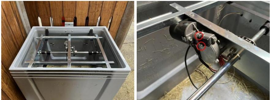
Retirez le capuchon noir du moteur pour exposer les engrenages. S'il y a beaucoup de graisse qui a été pressée contre la paroi du moteur, celle-ci peut être grattée à l'aide d'un tournevis fin et lubrifiée sur et entre les dents des engrenages. Si aucune graisse n'est visible, placez une cuillère à café de graisse blanche ou de vaseline sur et entre les engrenages.
