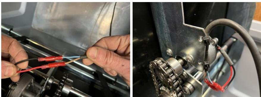
Placez le câble de connexion noir contre le métal de la base d'alimentation, il doit être orienté à l'opposé du moteur. Insérez un serre-câble dans le trou du métal de la base d'alimentation et serrez-le. Insérez un deuxième serre-câble dans le deuxième trou du métal de la base d'alimentation et serrez-le. Coupez les parties excédentaires des deux serre-câbles.
