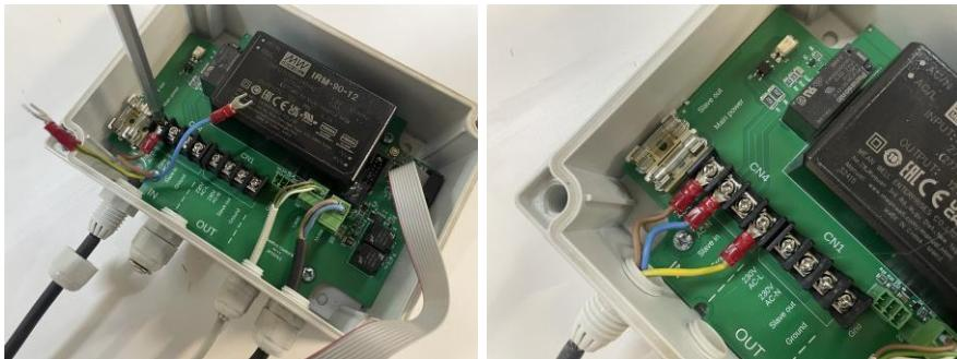
Tirez légèrement sur les fils tout en faisant glisser le cordon d'alimentation dans le pivot. Faites-le glisser jusqu'à ce qu'environ 5 mm de la gaine noire sorte du pivot. Serrez ensuite fermement le pivot à la main. Vérifiez que le cordon d'alimentation est bien fixé en le tirant hors de la commande ; il ne doit pas sortir du presse-étoupe.
