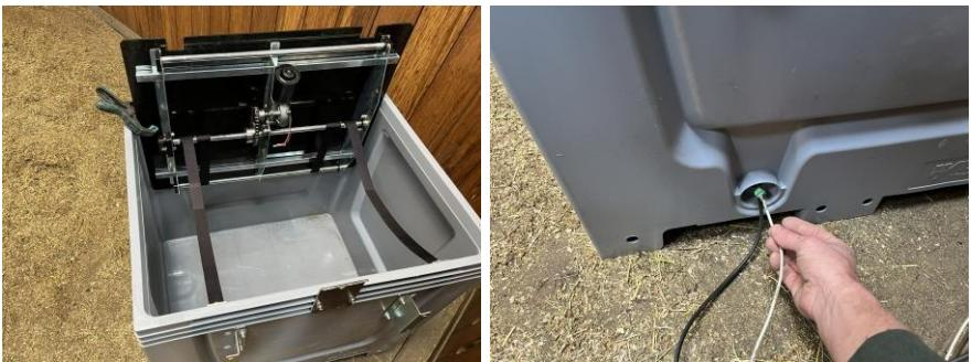
Pliez la base d'alimentation vers vous afin que les trous dans la paroi arrière soient visibles. Si nécessaire, fixez-la à l'aide d'une pince afin qu'elle reste en position verticale. Insérez les deux câbles de connexion dans le FeedingMaster à travers le trou situé dans le coin inférieur droit de la paroi arrière.
