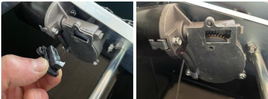
Remettez le capuchon noir sur le moteur et fixez-le à l'aide des deux vis, la vis la plus longue allant dans le trou supérieur. Vaporisez un peu de graisse blanche entre les essieux et les blocs de roulement noirs. Faites tourner les arbres de rotation plusieurs fois pour répartir la graisse.
