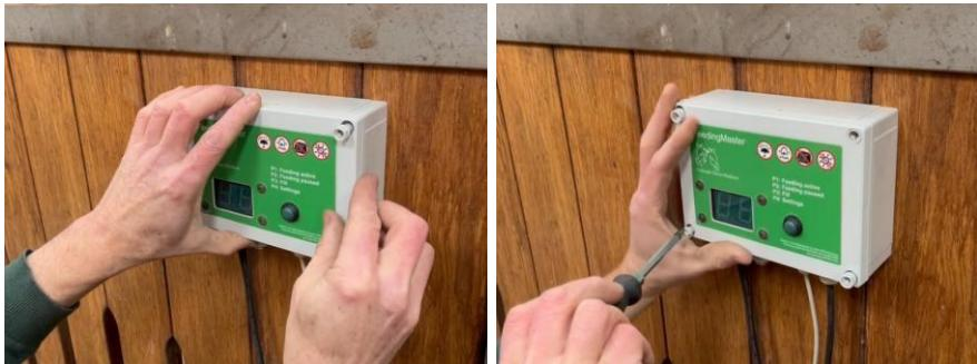
Serrez à la main les quatre vis grises situées aux coins du boîtier du contrôleur. Serrez-les ensuite d'un huitième de tour dans le sens des aiguilles d'une montre.
