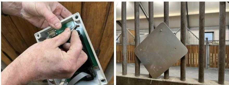
Déterminez la longueur appropriée des boulons à utiliser. Commencez par le boulon le plus court, insérez-le dans le trou de montage situé dans le coin inférieur droit du contrôleur à travers les barres. Placez la plaque de montage sur le boulon et mesurez la distance à laquelle il dépasse.
