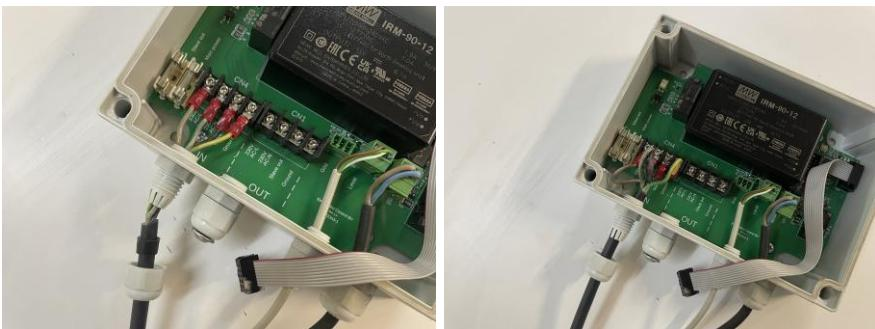
Tirez légèrement sur les fils tout en faisant glisser le câble de synchronisation dans le pivot. Faites-le glisser jusqu'à ce qu'environ 5 mm de la gaine noire sorte du pivot. Serrez ensuite fermement le pivot à la main. Vérifiez que le câble de synchronisation est bien fixé en le tirant hors du contrôleur ; il ne doit pas sortir du pivot.
