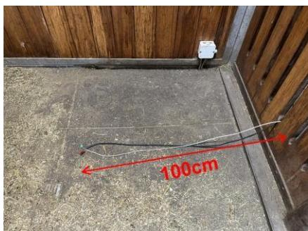
**AVERTISSEMENT** : ne dépassez pas la distance maximale entre le FeedingMaster et le contrôleur. Pendant le mouvement de la base d'alimentation, les câbles de connexion sont tirés dans le FeedingMaster. S'ils n'ont pas assez d'espace pour bouger, le moteur peut les déchirer, ce qui peut entraîner des dommages irréversibles.
