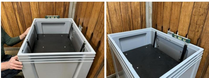
Vérifiez que le FeedingMaster est de niveau en profondeur et en largeur. Pour mettre le FeedingMaster de niveau, des plaques de réglage peuvent être placées sous les pieds du FeedingMaster, à condition qu'elles ne dépassent pas 5 mm d'épaisseur.
