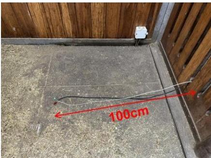
**AVERTISSEMENT :** ne dépassez pas la distance maximale entre le FeedingMaster et le contrôleur. Pendant le déplacement de la base d'alimentation, les câbles de connexion sont tirés dans le FeedingMaster. S'ils ne disposent pas d'un espace suffisant pour bouger, le moteur peut les arracher, ce qui peut entraîner des dommages irréversibles.
