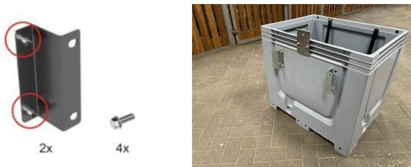
Insérez les boulons à bride de l'intérieur à travers les plus petits trous de la paroi arrière du FeedingMaster. Vissez les boulons dans les douilles du support de montage et serrez-les.
