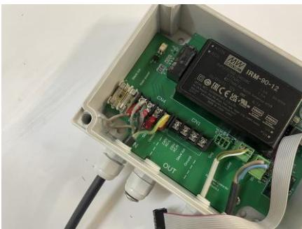
Sur l'esclave, un FeedingMaster supplémentaire peut être synchronisé à l'aide d'un câble de synchronisation connecté aux bornes du connecteur marqué CN1 (Out) sur la commande. Dans ce cas, suivez les instructions indiquées dans la section « Connexion au maître » pour connecter le câble de synchronisation au FeedingMaster supplémentaire.
