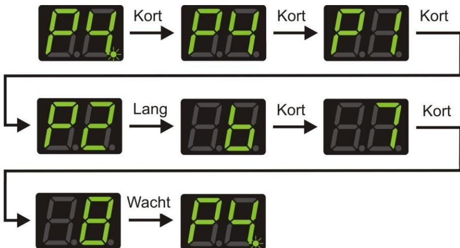
Dans le même exemple, si le programme actif est P2, activez les paramètres en appuyant brièvement puis en maintenant le bouton enfoncé :
