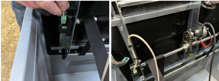
Placez le câble de connexion gris contre le métal de la base d'alimentation, il doit être orienté à l'opposé du capteur. Insérez un serre-câble dans le trou métallique de la base d'alimentation et serrez-le. Insérez un deuxième serre-câble dans le deuxième trou métallique de la base d'alimentation et serrez-le. Coupez les parties excédentaires des deux serre-câbles.
