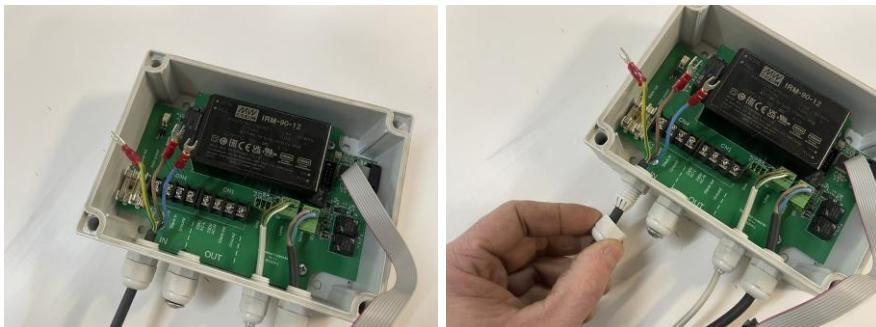
Pour faciliter le passage du câble de synchronisation, le raccord pivotant peut être complètement dévissé. Faites-le glisser sur le câble de synchronisation. Vous pouvez également retirer la bague en caoutchouc noir du presse-étoupe qui est toujours vissé dans le boîtier. Faites également glisser la bague en caoutchouc sur le câble de synchronisation.
