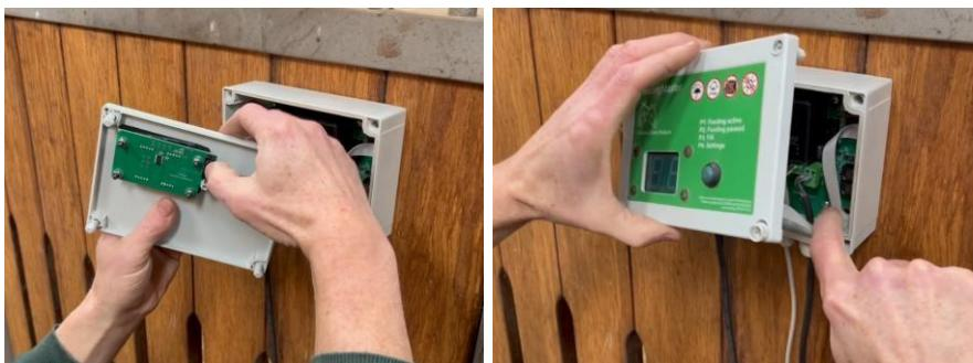
Placez le panneau avant devant le contrôleur. Poussez le câble du panneau avant vers le coin inférieur droit du boîtier. Placez le panneau avant sur le contrôleur. Vérifiez qu'il s'emboîte parfaitement avec le boîtier sur tous les côtés. Le panneau avant doit toucher le boîtier sans résistance, ne le forcez jamais s'il ne s'emboîte pas correctement. Dans ce cas, vérifiez qu'il n'y a pas de câbles entre le panneau avant et le contrôleur.
