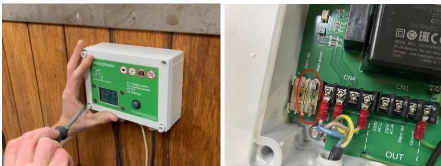
Dans le coin inférieur gauche du boîtier de commande, deux fusibles sont visibles. Le fusible de gauche sert à protéger l'entrée esclave, celui de droite est le fusible principal du boîtier de commande. Retirez-le en le faisant basculer hors de son support. Vérifiez si le fusible est défectueux. Si c'est le cas, remplacez-le par un fusible du même type (250 VCA, 1 A, lent, 5 x 20 mm).
