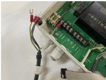
Faites maintenant passer un fil à la fois à travers le pivot dans le contrôleur et connectez la cosse de câble fourchue au connecteur. Les deux côtés du câble de synchronisation sont identiques, vous pouvez donc utiliser n'importe quel côté. Connectez ensuite le fil suivant.
