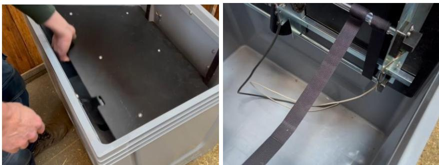
Abaissez doucement la base d'alimentation pour la remettre en place. Rabatbez-la ensuite vers l'arrière. Vérifiez que les deux câbles de connexion peuvent bouger librement et ne sont pas coincés entre les sangles de suspension et le moteur. Les deux câbles de connexion doivent passer sous les sangles de suspension avant. Abaissez doucement la base d'alimentation pour la remettre en place.
