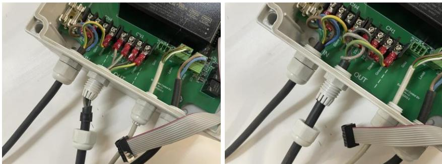
Serrez ensuite fermement le pivot à la main. Vérifiez que le câble de synchronisation est bien fixé en le tirant hors du contrôleur ; il ne doit pas sortir du pivot.
