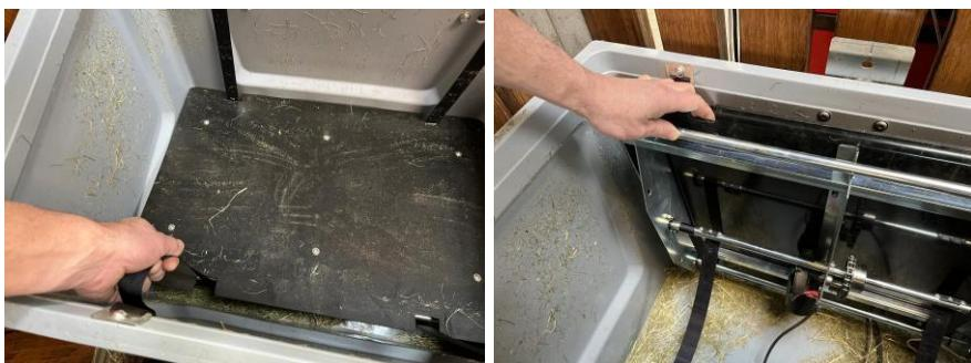
**AVERTISSEMENT** : Ne jamais incliner la base d'alimentation vers l'avant. Cela pourrait entraîner le coincement des câbles d'entraînement dans le mécanisme d'entraînement et causer des dommages irréversibles.
