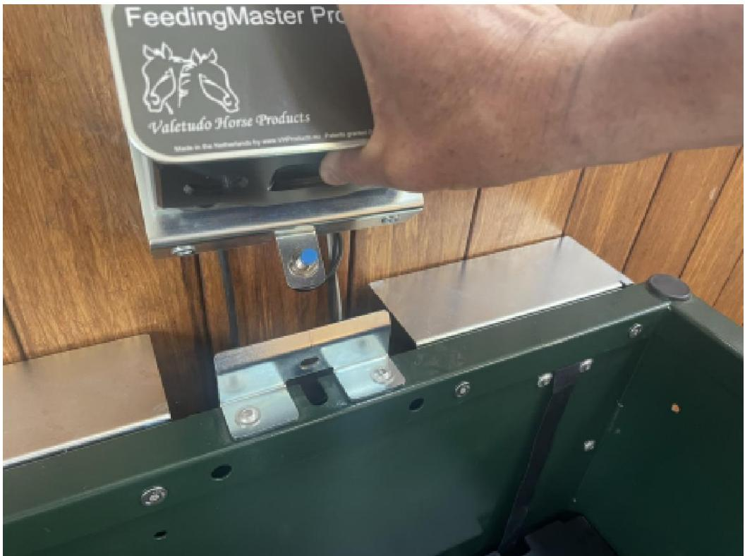
[ ] Inclinez le contrôleur à 90 degrés dans le sens des aiguilles d'une montre et placez-le sur le support de fixation droit.
