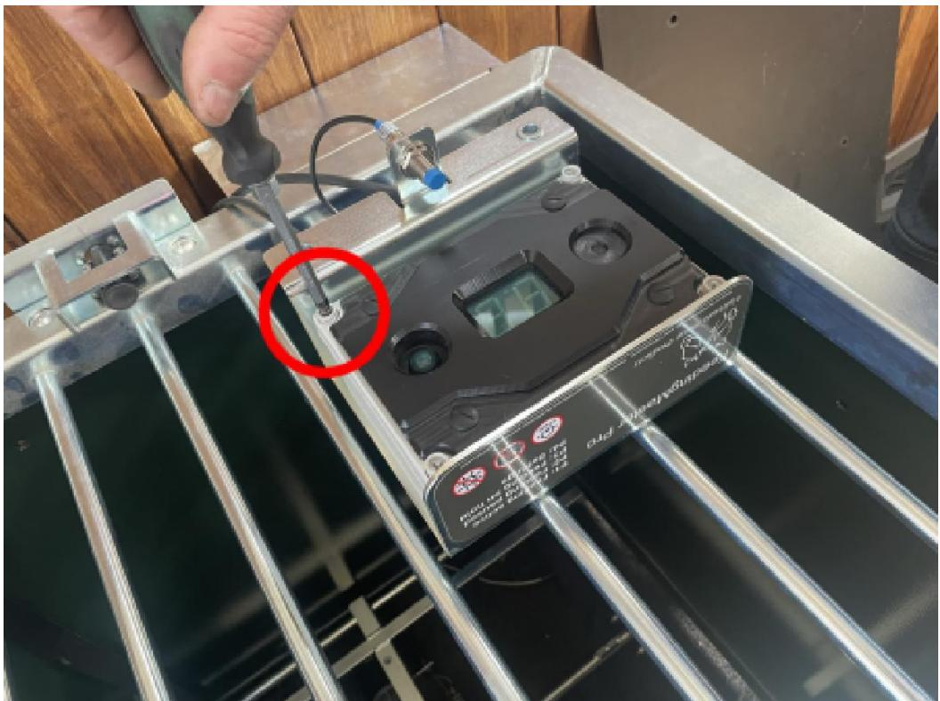
[ ] Placez l'avant du boîtier du contrôleur à côté du contrôleur. Faites passer le câble du moteur à travers le dispositif de décharge de traction dans le boîtier du contrôleur. Ne le serrez pas encore.
