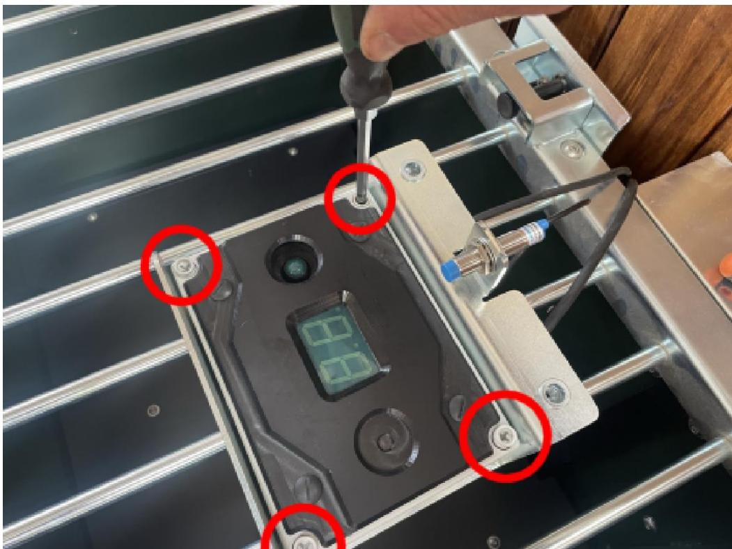
**AVERTISSEMENT :** Si les écrous sont trop serrés, le joint en silicone entre l'avant et l'arrière du boîtier sera écrasé et les deux pièces ne seront plus étanches. De l'humidité peut alors se condenser dans le boîtier, provoquant un dysfonctionnement du contrôleur.
