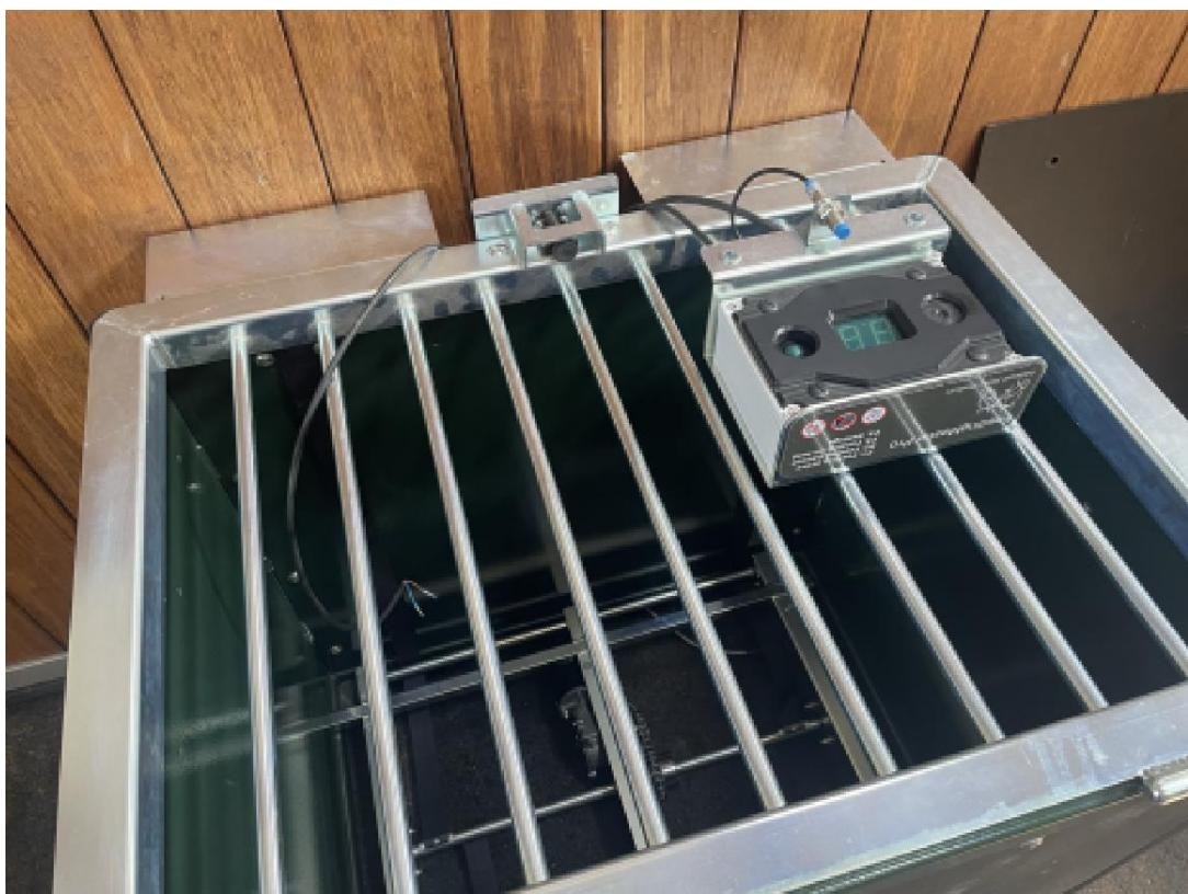
[ ] Dévissez l'écrou à l'avant du boîtier du contrôleur.
