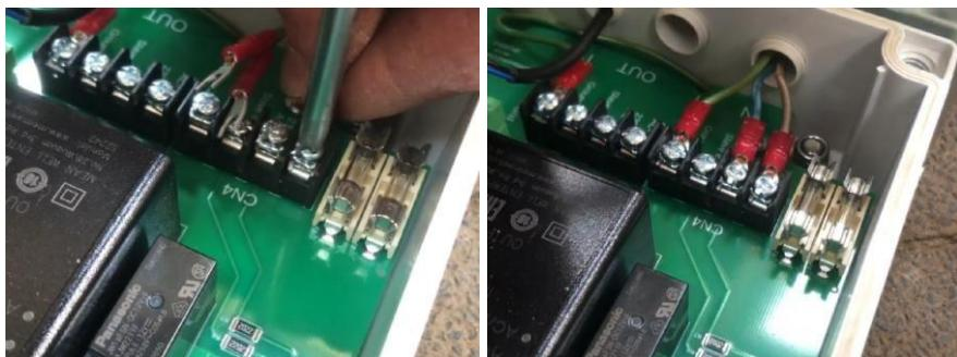
Tirez légèrement sur les fils pendant que vous insérez le cordon d'alimentation dans le pivot. Faites-le glisser jusqu'à ce qu'environ 5 mm de la gaine noire sorte du pivot. Serrez ensuite fermement le pivot à la main. Vérifiez que le cordon d'alimentation est bien fixé en le tirant hors du contrôleur ; il ne doit pas sortir du pivot.
