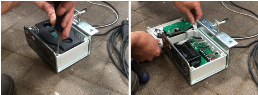
Dévissez le pivot du serre-câble à travers lequel passe le cordon d'alimentation. Dévissez les trois connexions du connecteur marqué CN4 (In) sur le contrôleur de deux tours. Retirez les cosses à fourche en les faisant glisser sous les bornes. Retirez le cordon d'alimentation en tirant les trois cosses à fourche les unes après les autres.
