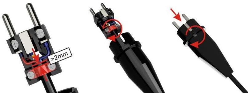
Il y a un trou dans la plaque de mise à la terre centrale à l'avant de la fiche d'alimentation. Tournez le boîtier de la fiche d'alimentation de manière à ce que la vis de verrouillage dans le boîtier se trouve au niveau de ce trou, puis glissez la fiche d'alimentation dans le boîtier. Serrez ensuite la vis de verrouillage.
