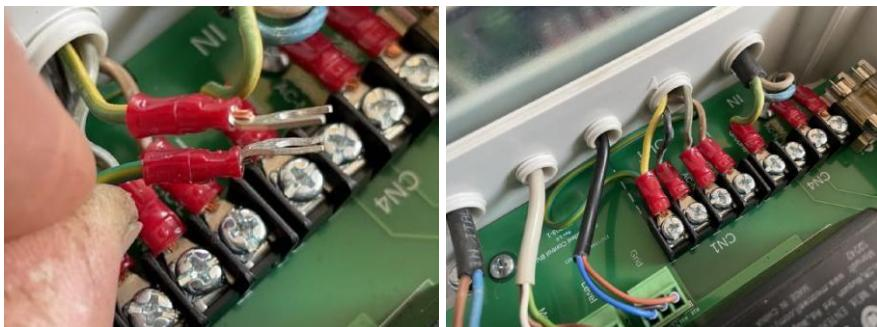
Tirez légèrement sur les fils tout en faisant glisser le câble de synchronisation dans le pivot. Faites-le glisser jusqu'à ce qu'environ 5 mm de la gaine noire sorte du pivot. Serrez ensuite fermement le pivot à la main. Vérifiez que le câble de synchronisation est bien fixé en le tirant hors de l'unité de commande ; il ne doit pas sortir du pivot.
