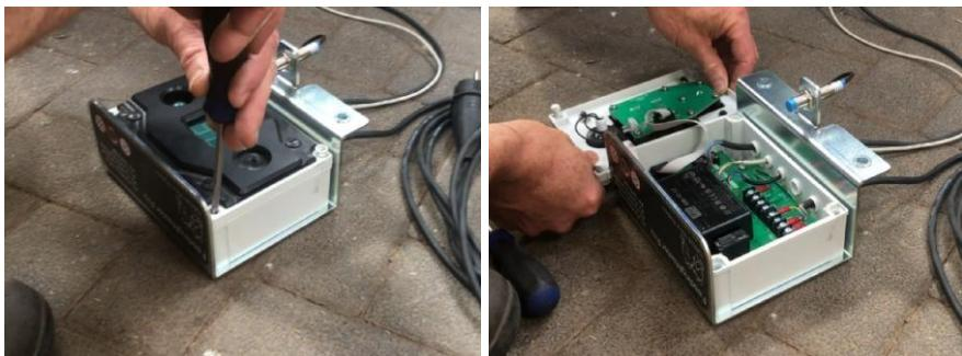
En plus du presse-étoupe par lequel passe le cordon d'alimentation, un deuxième presse-étoupe est présent pour le câble de synchronisation. Il est équipé d'un boulon à bride M6 pour le sceller. Dévissez le pivot et retirez le boulon à bride.
