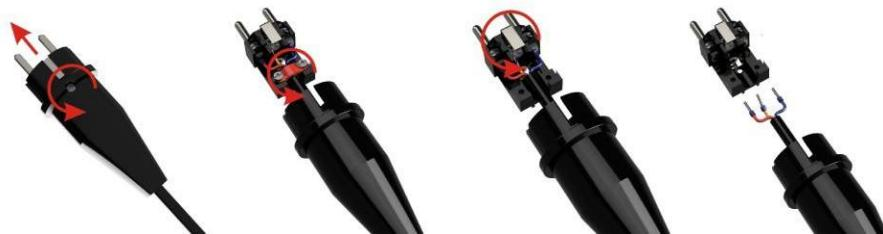
Dévissez et retirez les deux vis du serre-câble. Desserrez d'un tour les trois vis qui fixent les fils de connexion à la fiche d'alimentation. Le cordon d'alimentation peut être retiré.
