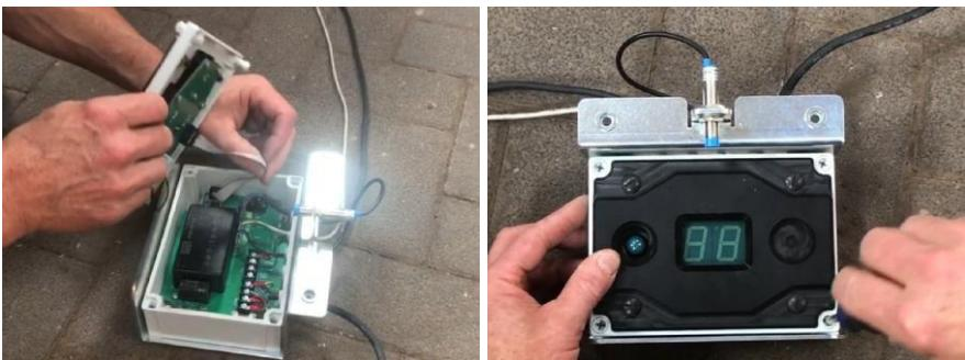
Serrez à la main les quatre vis grises situées aux coins du boîtier du contrôleur. Tournez-les ensuite d'un huitième de tour dans le sens des aiguilles d'une montre.
