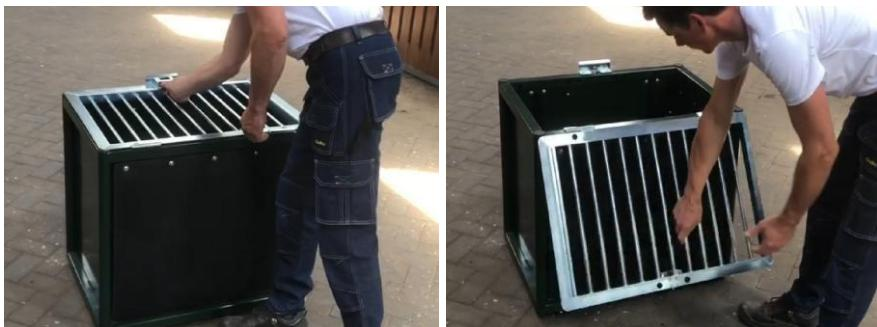
Retirez les supports de montage et la boîte de matériel d'installation du FeedingMaster. Inclinez légèrement la grille pour l'éloigner du rabat de protection en caoutchouc, puis inclinez le FeedingMaster vers l'avant de manière à ce qu'il reste incliné. Soulevez le contrôleur avec le cordon d'alimentation dans une main et inclinez la base d'alimentation vers l'avant avec l'autre main.
