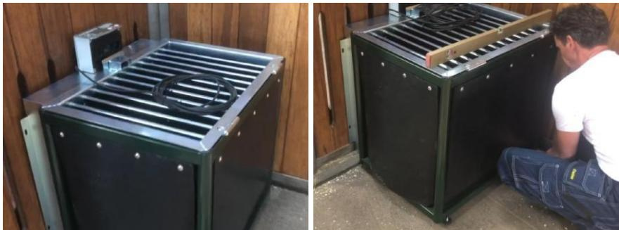
Si ce n'est pas le cas, déterminez quel angle est le plus élevé. Les autres coins peuvent être relevés à l'aide des pieds réglables. Commencez par un coin adjacent au coin le plus élevé. Placez le niveau à bulle entre les deux coins et tournez le pied réglable dans le sens des aiguilles d'une montre, vu d'en haut, jusqu'à ce que ce côté soit à niveau.
