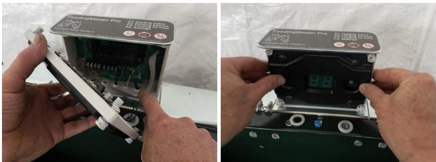
**AVERTISSEMENT** : ne placez jamais le panneau avant sur le contrôleur en biais. Le contrôleur ne serait plus étanche, ce qui pourrait entraîner des dysfonctionnements et des dommages.
