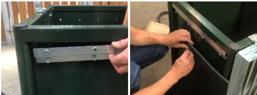
Placez-le devant le trou correspondant dans le support de suspension et vissez-le à la main. Enfoncez les quatre boulons à bride M8x25 restants dans les trous de la plaque en caoutchouc et serrez-les à la main.
