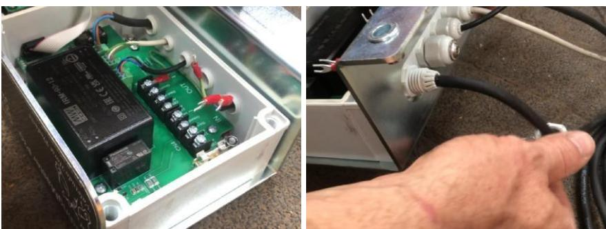
Retirez le cordon d'alimentation en retirant les trois cosses à fourche du pivot, l'une après l'autre. Installez le cordon d'alimentation de 10 mètres en insérant les trois cosses à fourche, l'une après l'autre, dans le pivot.
