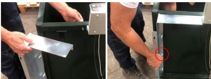
Installez le deuxième boulon à tête fraisée M8x60 et le deuxième boulon à bride M8x20. Répétez l'opération pour l'autre support de montage.
