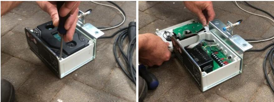
Dévissez le pivot du serre-câble à travers lequel passe le cordon d'alimentation. Dévissez les trois connexions du connecteur marqué CN4 (In) sur le contrôleur de deux tours. Retirez les cosses à fourche en les faisant glisser sous les bornes.
