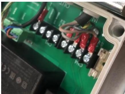
Sur l'esclave, un autre FeedingMaster peut être connecté à l'aide d'un câble de synchronisation aux connexions du connecteur du contrôleur marqué CN1 (Out). Dans ce cas, suivez les instructions indiquées dans le chapitre « Connexion au maître » pour connecter le câble de synchronisation à l'esclave.
