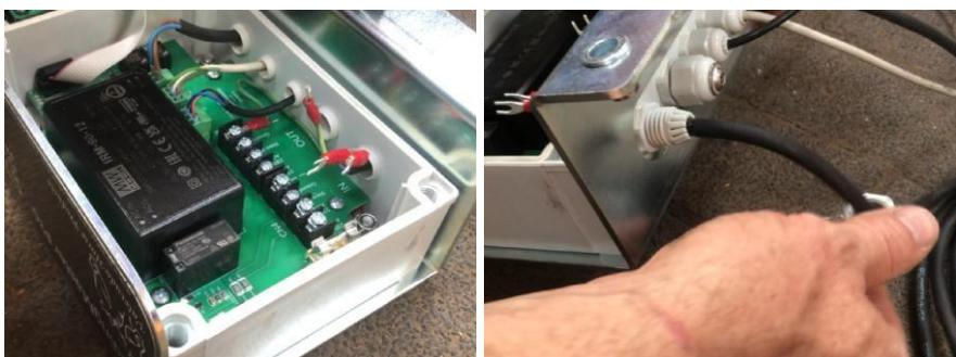
Placez le câble de synchronisation en insérant les quatre cosses à fourche les unes après les autres dans le presse-étoupe. Les deux côtés du câble de synchronisation sont identiques, vous pouvez donc utiliser n'importe quel côté.
