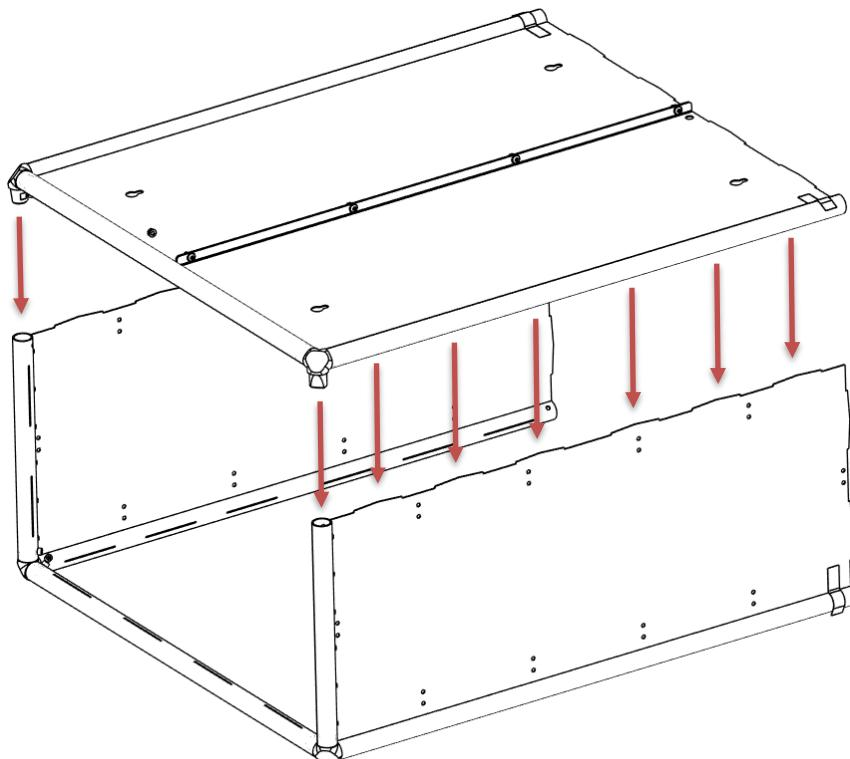
Setzen Sie **zwei 20 mm lange Inbusschrauben** ein und drehen Sie sie leicht ein. Befestigen Sie die Enden der langen Rohre mit Klebeband an den Seitenwänden.
