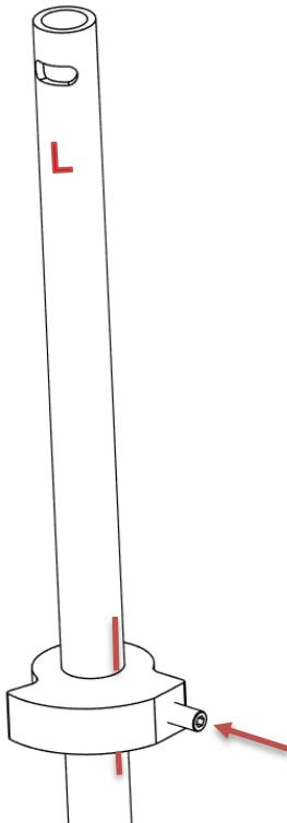
Drehen Sie die Stellschraube nach innen. Wenn Sie einen Widerstand spüren, bevor die Stellschraube vollständig sitzt:
