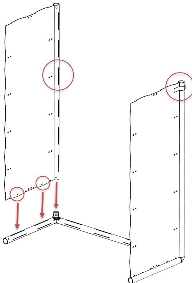
**ACHTUNG:** Stellen Sie sicher, dass sich die kleinen ovalen Schlitze unten befinden und alle nicht verwendeten Schlitze nach innen in Richtung des gegenüberliegenden Eckstücks zeigen.
