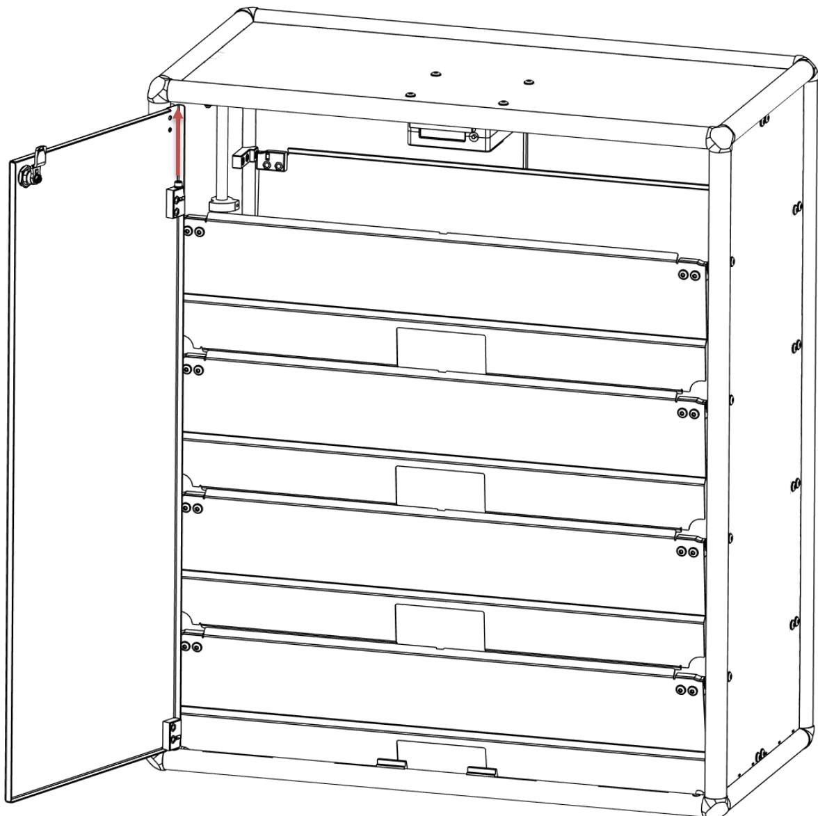
Halten Sie das Scharnier fest und üben Sie dabei Druck auf die Muttern aus. Führen Sie beide Halbrundschrauben durch die Tür in das Scharnier ein. Schrauben Sie sie ein und ziehen Sie sie mit einem Inbusschlüssel fest an.
