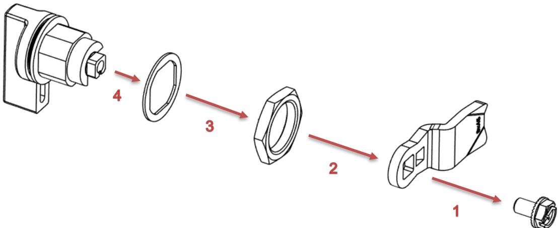
Überprüfen Sie die Ausrichtung der beiden Slitzen im Schlosskörper. Falls erforderlich:
