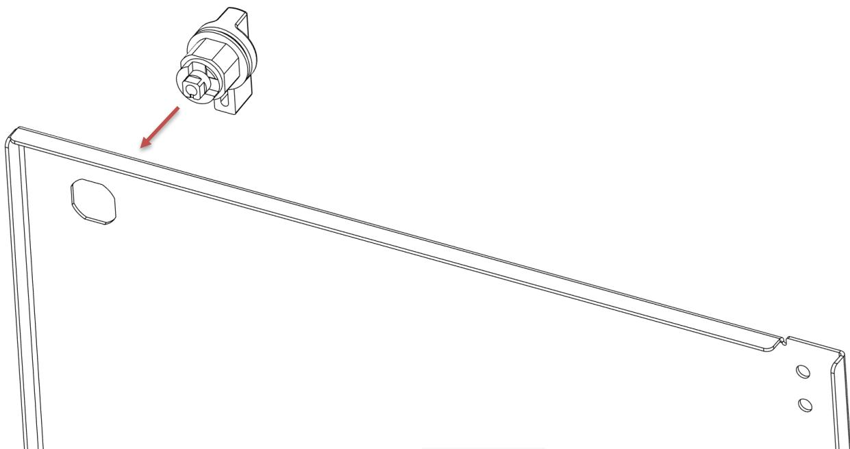
**ACHTUNG:** Stellen Sie sicher, dass der Knopf **nach unten** zeigt und die beiden Slits im Schlosskörper genau wie in der Referenzabbildung ausgerichtet sind.
