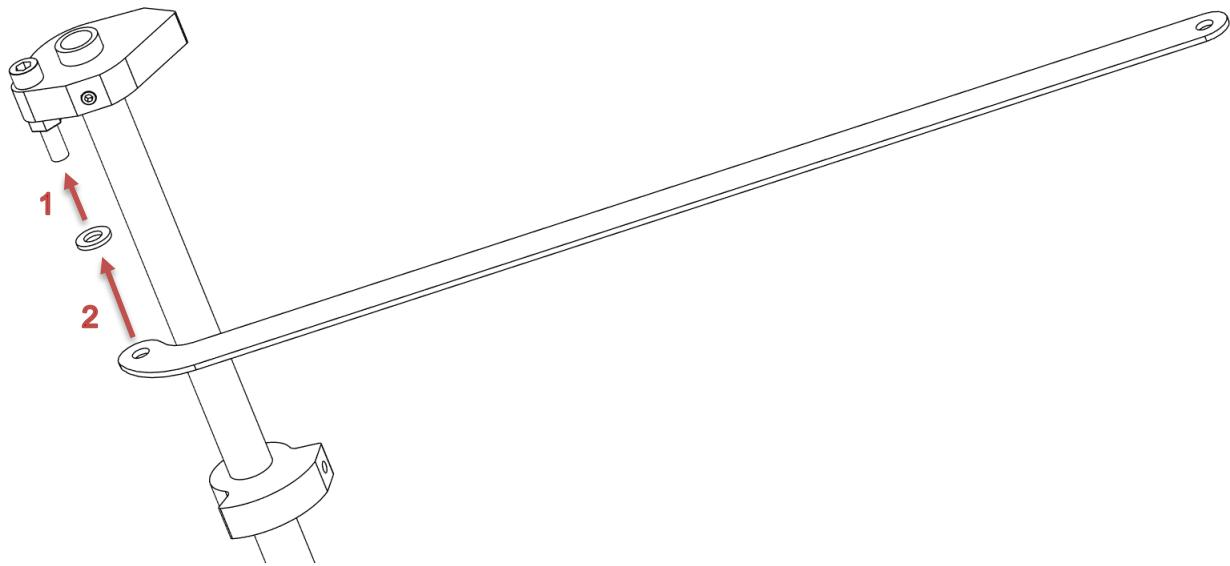
Legen Sie eine zweite Unterlegscheibe auf die Schraube. Schrauben Sie eine **Sicherungsmutter** (mit blauem Nyloneneinsatz) auf. Ziehen Sie die Sicherungsmutter fest, bis Sie einen Widerstand spüren, und lösen Sie sie dann um etwa **1/16 Umdrehung**. Die Verbindungsplatte muss sich frei drehen lassen und nur ein minimales Axialspiel aufweisen.
