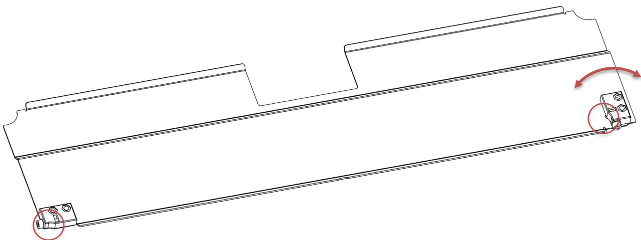
**ACHTUNG:** Vergewissern Sie sich, dass die kreisförmigen Ausschnitte genau wie in der Referenzabbildung positioniert sind. Eine falsche Ausrichtung verhindert den ordnungsgemäßen Betrieb.
