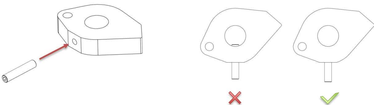
Setzen Sie die Nockenwelle senkrecht mit der Langlochbohrung nach oben ein. Schieben Sie den Antriebsblock auf die Nockenwelle und richten Sie die Stellschraube an der Langlochbohrung aus. Drehen Sie die Stellschraube ein.
