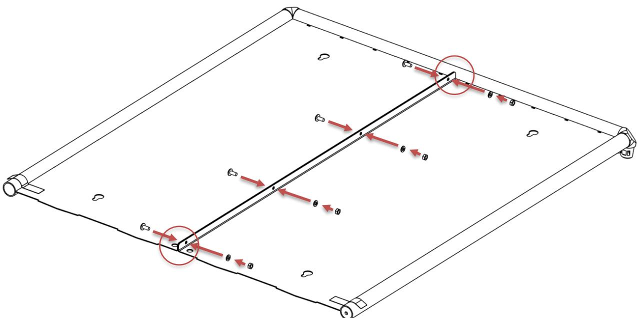
**ACHTUNG:** Die Flansche müssen genau ausgerichtet sein, ohne horizontale oder vertikale Überlappung.
