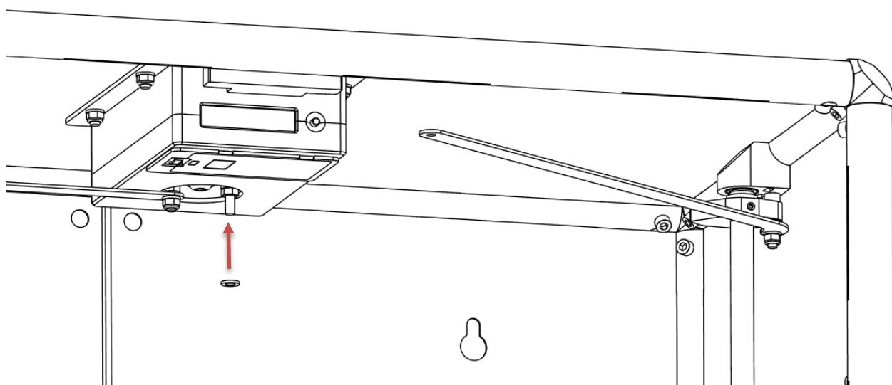
Ziehen Sie die Verbindungsplatte leicht nach unten und setzen Sie sie über die rechte Schraube des Steuergerät. Fügen Sie eine zweite Unterlegscheibe hinzu und schrauben Sie eine **Sicherungsmutter** (mit blauem Nyloneneinsatz) auf.
