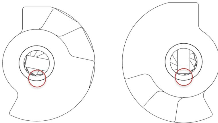
**ACHTUNG:** Überprüfen Sie diese Ausrichtung dreifach. Wenn die Nockensperren falsch eingebaut sind, funktionieren die Falltüren nicht richtig und die Nockenwelle muss überholt werden.
