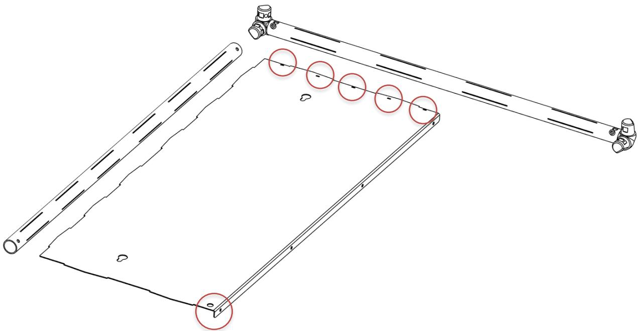
**ACHTUNG:** Wenn der Flansch nach oben zeigt, haben Sie das falsche Teil der Rückwand. Ersetzen Sie es durch das andere.
