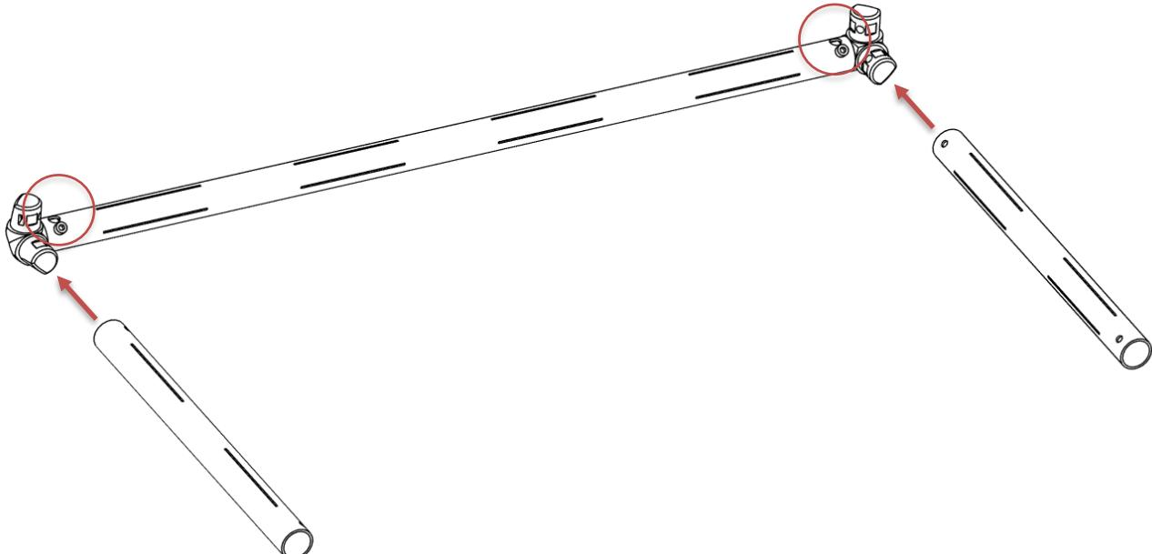
**ACHTUNG:** Überprüfen Sie die Ausrichtung des großen Lochs. Dieses Loch wird später für das Türscharnier verwendet.
