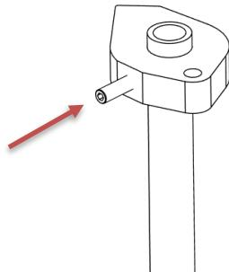
Positionieren Sie den Antriebsblock so, dass sich die Stellschraube **ungefähr in der Mitte der Langlochbohrung** befindet. Dies ist die Neutralstellung, die in den meisten Fällen korrekt funktioniert. Drehen Sie die Stellschraube ein, bis sie den Antriebsblock fast vollständig auf der Nockenwelle festklemmt. Die Nockenwelle muss sich mit leichter Handkraft drehen lassen. Das endgültige Festziehen erfolgt während der Feineinstellung der Nockenwelle im letzten Kapitel.
