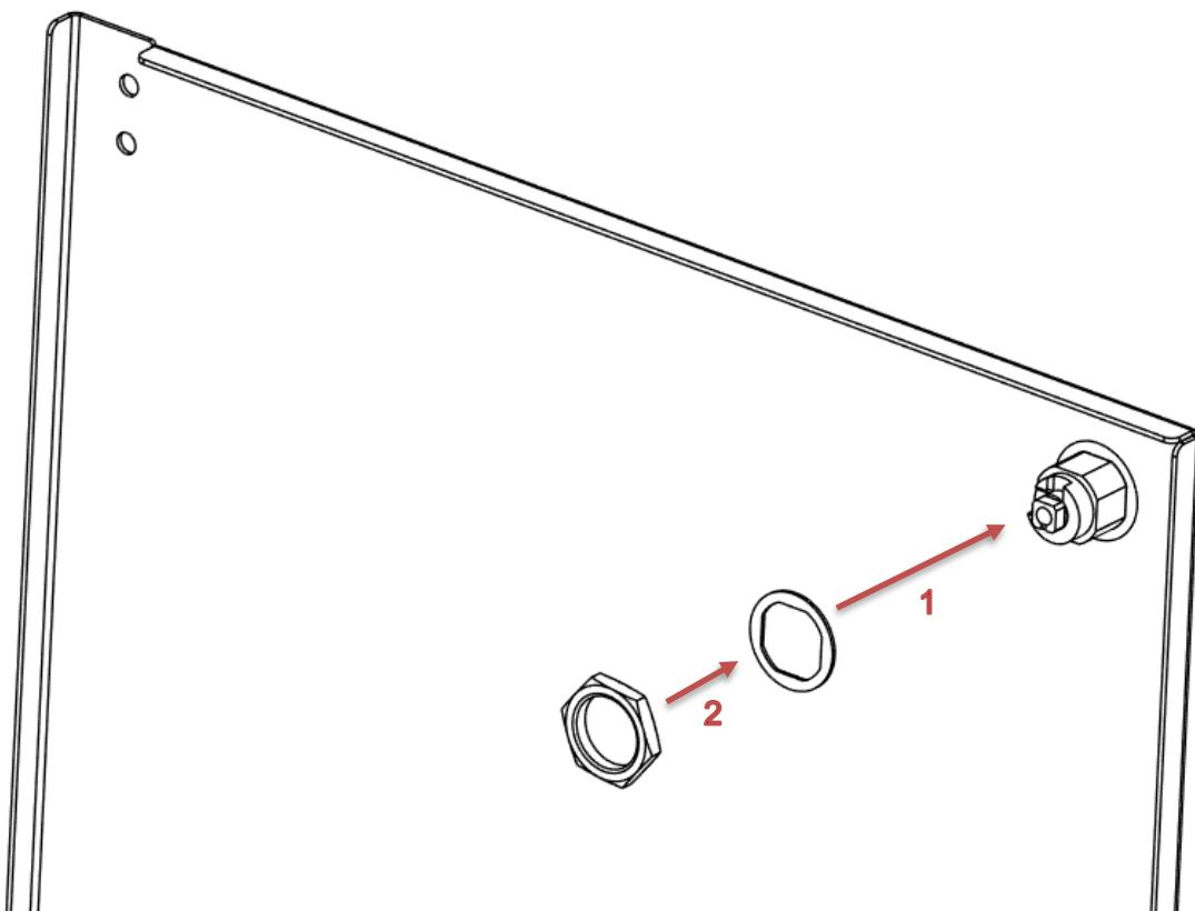
Stellen Sie sicher, dass der Knopf nach unten zeigt, und positionieren Sie die Verriegelungszunge **nach oben**. Setzen Sie die Schraube ein und ziehen Sie sie mit einem **10-mm-Ringschlüssel** fest an.
