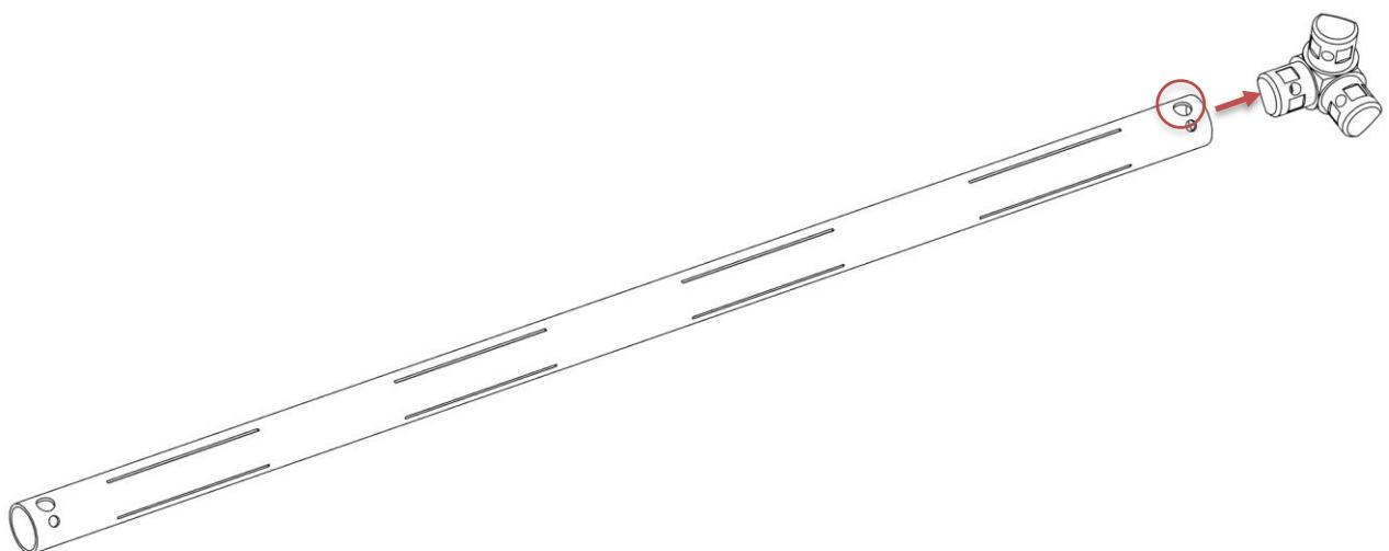
**ACHTUNG:** Überprüfen Sie die Ausrichtung des großen Lochs noch einmal. Dieses Loch wird später für das Türscharnier verwendet.
