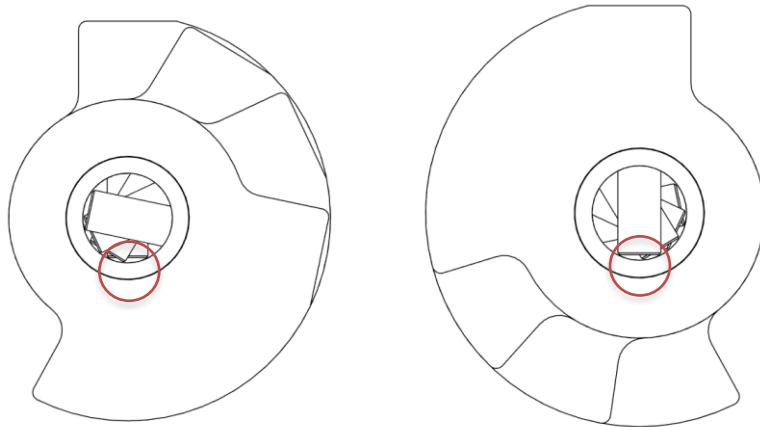
**ATTENTION :** Vérifiez trois fois cette orientation. Si les cames sont mal installées, les trappes ne fonctionneront pas correctement et l'arbre à cames devra être reconstruit.
