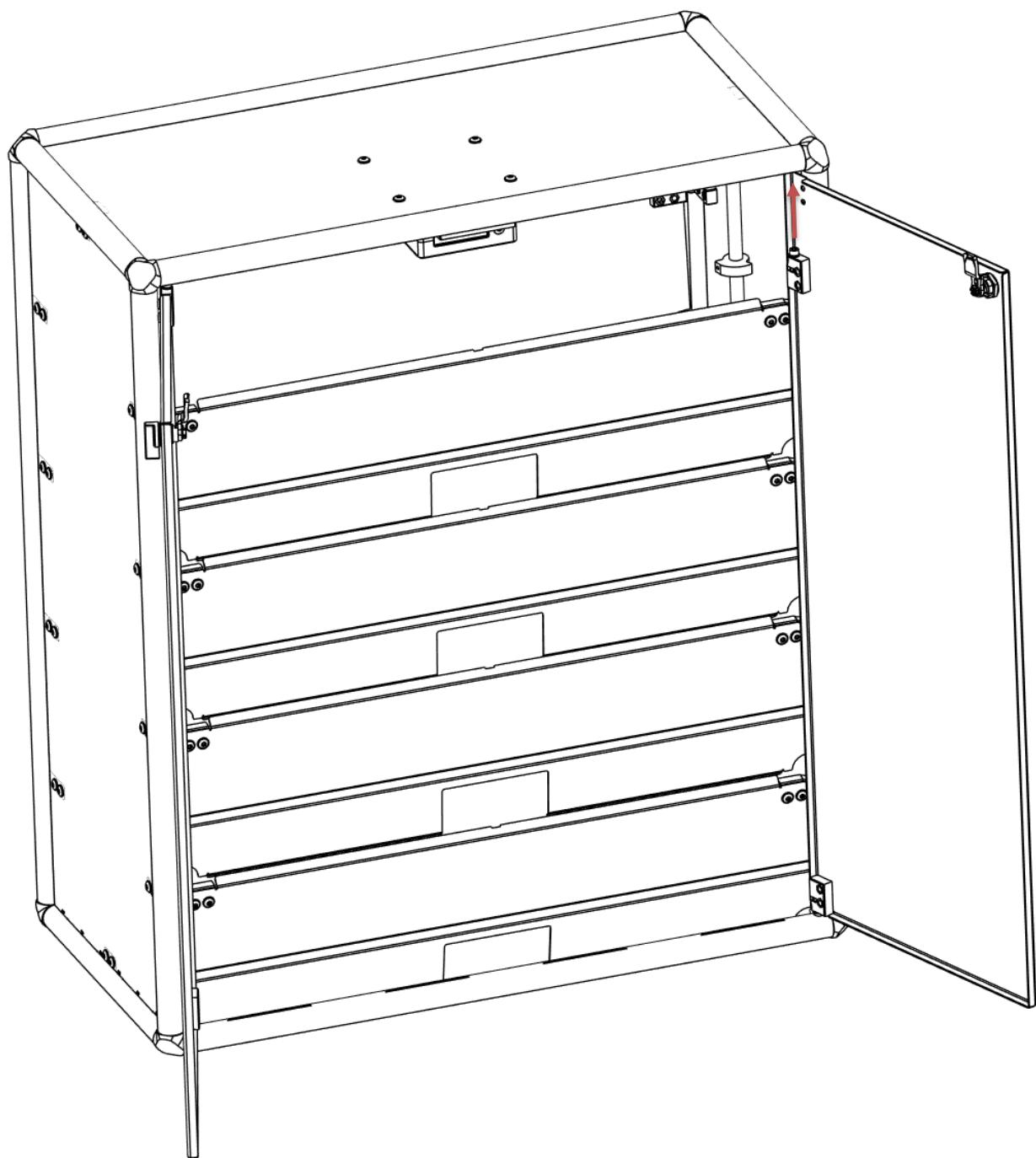
Maintenez la charnière en place en exerçant une pression sur les écrous. Insérez les deux boulons à tête bombée. Vissez-les et serrez-les fermement à l'aide d'une clé Allen.
