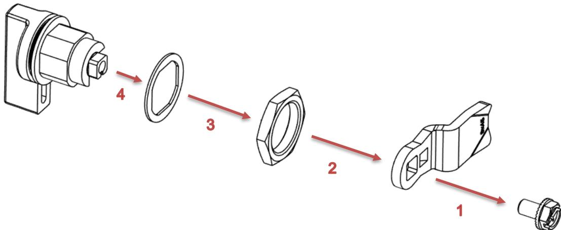
Vérifiez l'orientation des **deux fentes** dans le corps de la serrure. Si l'orientation ne correspond pas à l'image de référence :
