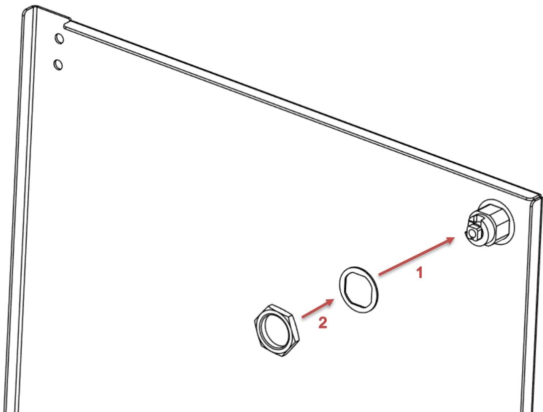
Assurez-vous que le bouton est orienté vers le bas et positionnez la languette de verrouillage **vers le haut**. Insérez le boulon et serrez fermement à l'aide d'une **clé à anneau de 10 mm**.
