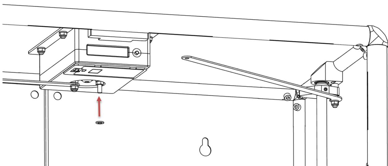
Tirez légèrement la plaque de liaison vers le bas et placez-la sur le boulon droit du contrôleur. Ajoutez une deuxième rondelle et vissez un **écrou de blocage** (avec insert en nylon bleu).
