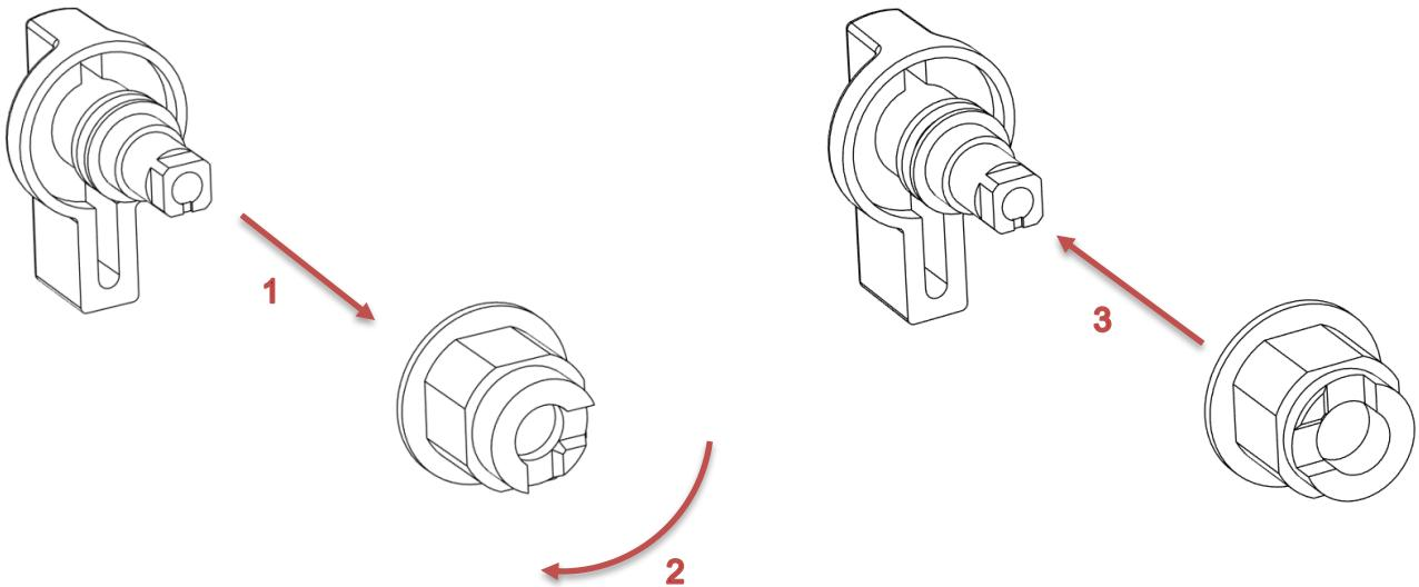
Insérez le bouton et le corps de serrure dans le trou octogonal.
