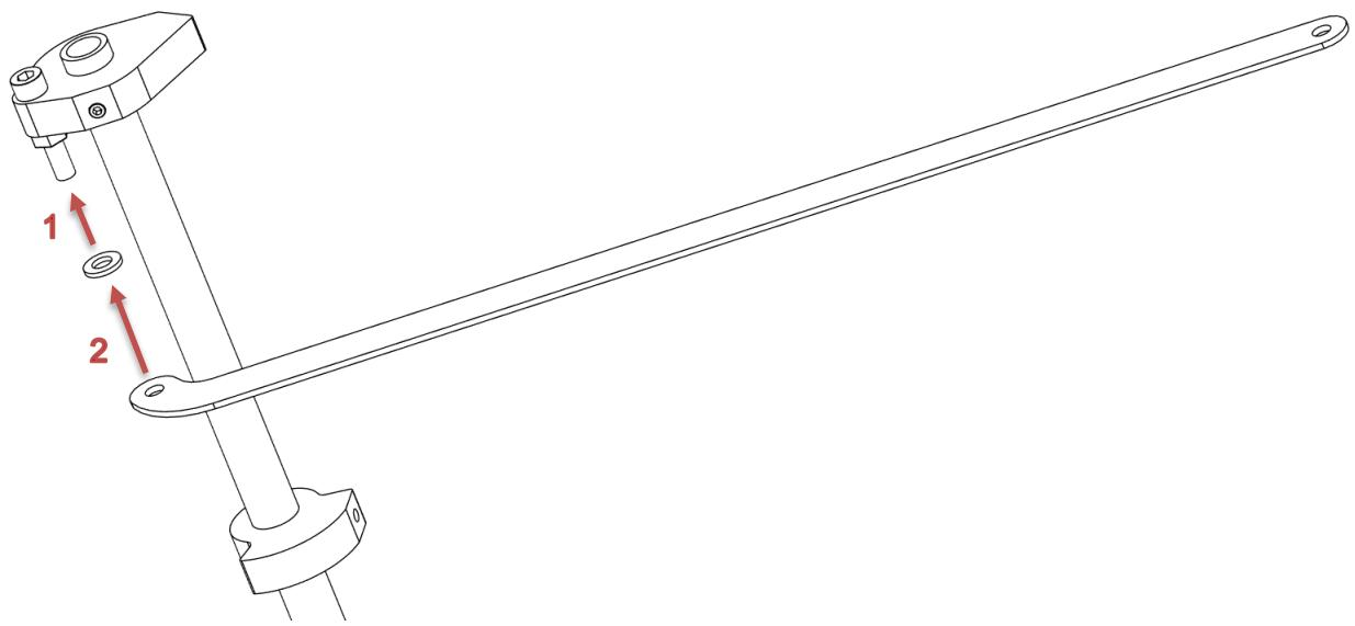
Placez une deuxième rondelle sur le boulon. Vissez un **contre-écrou** (avec insert en nylon bleu). Serrez le contre-écrou jusqu'à ce que vous sentiez une résistance, puis desserrez-le d'environ **1/16 de tour**. La plaque de liaison doit tourner librement avec un jeu axial minimal.
