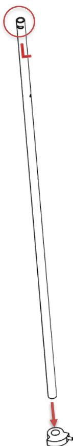
Faites glisser le bloc à came vers le haut jusqu'à ce qu'il atteigne le **trou marqué en haut**. Alignez la vis de réglage avec le trou marqué dans le tube en acier inoxydable.
