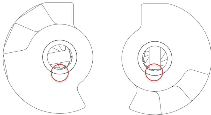
**ATTENTION :** Vérifiez trois fois l'orientation depuis le haut et depuis le bas. Si les cames sont mal installées, les trappes ne s'ouvriront pas dans le bon ordre et l'arbre à cames devra être démonté et remonté.
