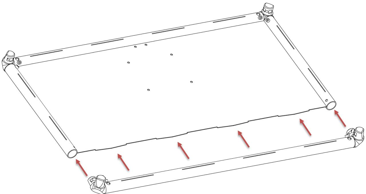
Insérez un **boulon Allen de 20 mm de long** à travers le tube dans chaque pièce d'angle et vissez-les légèrement.
