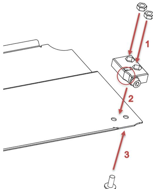
La trappe doit ressembler à l'image ci-dessous. Répétez cette procédure pour les **trois autres trappes avant**.
