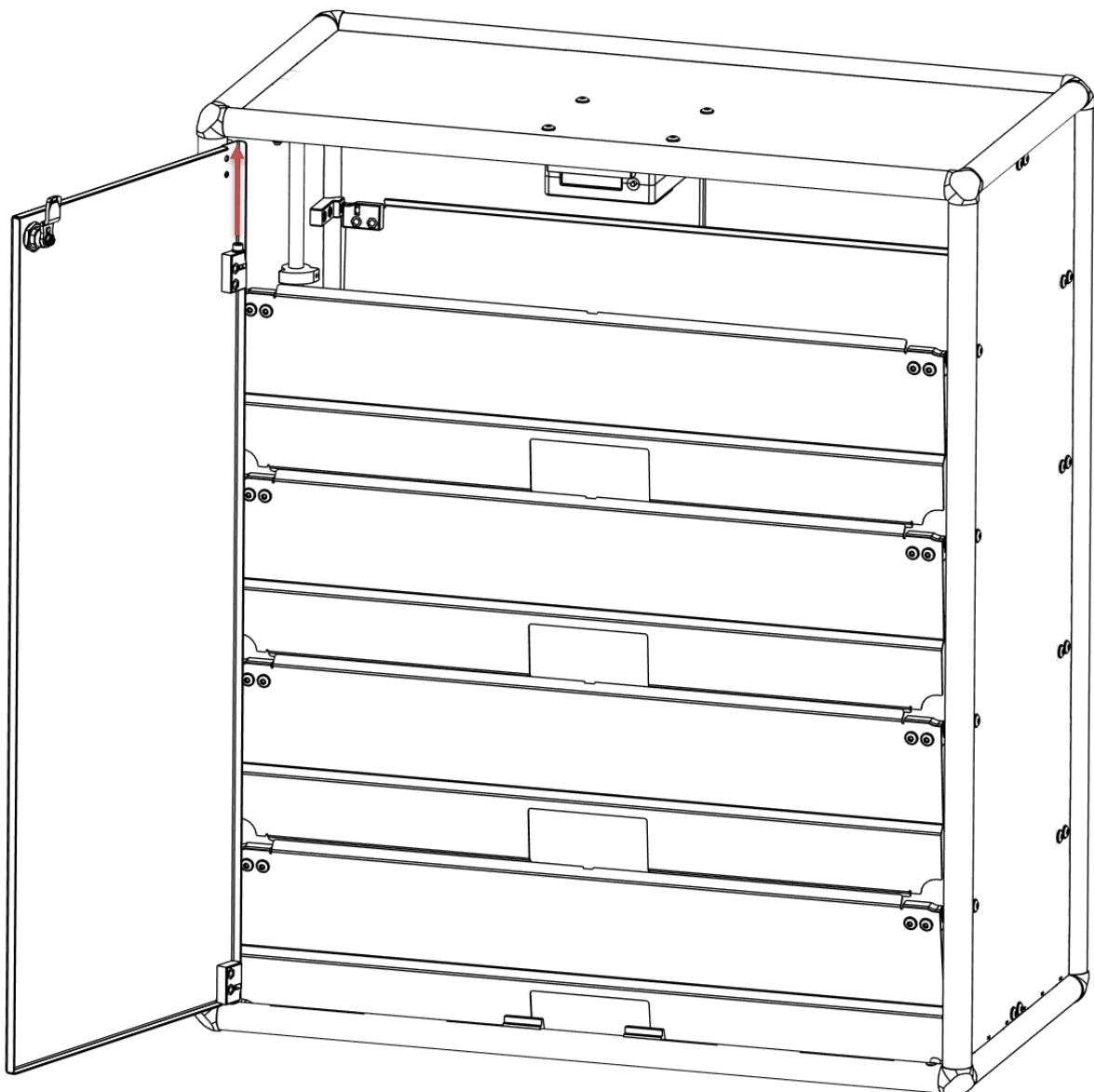
Maintenez la charnière en place en exerçant une pression sur les écrous. Insérez les deux boulons à tête bombée à travers la porte dans la charnière. Vissez-les et serrez-les fermement à l'aide d'une clé Allen.
