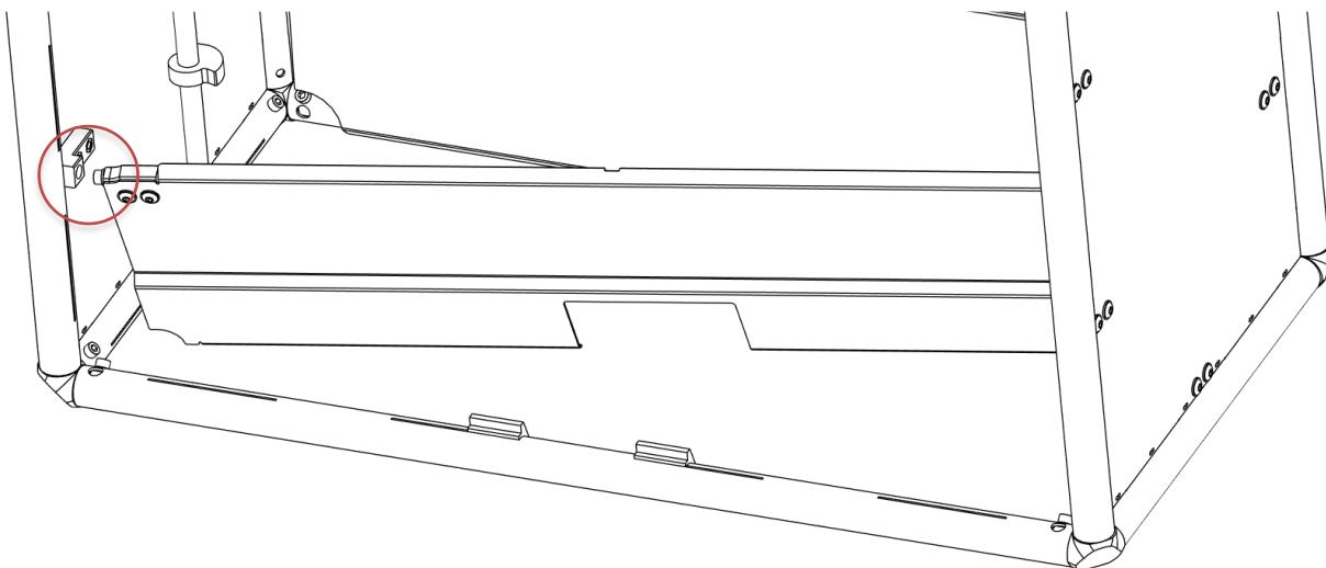
Déplacez le côté droit de la trappe vers la charnière droite de l'armoire. Tournez la charnière de la trappe **dans le sens des aiguilles d'une montre** jusqu'à ce qu'elle s'enclenche dans la charnière de l'armoire et que le trou situé derrière l'écrou inutilisé s'aligne avec le trou de la trappe.
