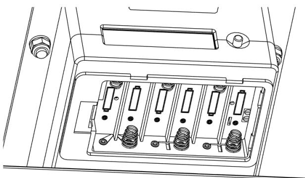
Lorsque la dernière pile est insérée, le HayTimer s'allume automatiquement et l'écran s'active.
