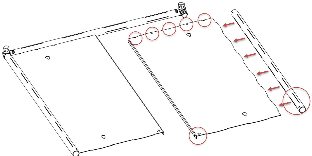
Appuyez sur les deux tôles du panneau arrière pour que les petites brides se rejoignent. Faites glisser le tube et la tôle sur le bout horizontal de la pièce d'angle droite. Guidez les languettes de la tôle dans les fentes du tube de longueur moyenne.
