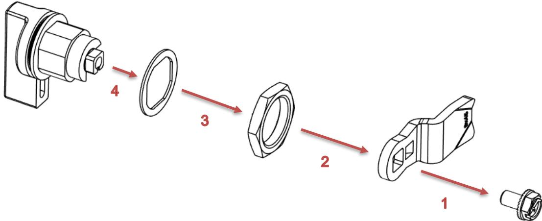
Vérifiez l'orientation des deux fentes dans le corps de la serrure. Si nécessaire :
