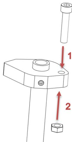
Placez une rondelle sur le boulon Allen. Installez la **plaquette de liaison en acier inoxydable** à l'aide du trou situé à l'**extrémité courbée** de la plaque. Assurez-vous que la plaque de liaison est orientée comme indiqué sur l'image de référence.
