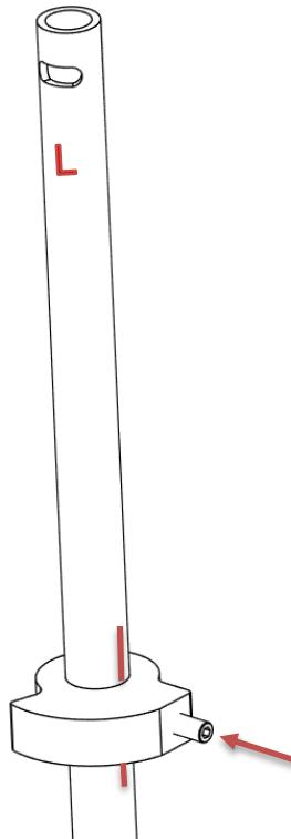
Vissez la vis de réglage vers l'intérieur. Si vous sentez une résistance avant que la vis de réglage ne soit complètement enfoncee :
