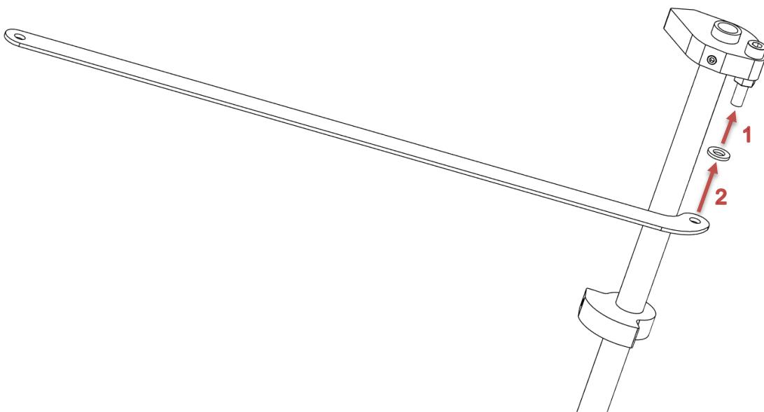
Placez une deuxième rondelle sur le boulon. Vissez un **écrou de blocage** (avec insert en nylon bleu). Serrez l'écrou de blocage jusqu'à ce que vous sentiez une résistance, puis desserrez-le d'environ **1/16 de tour**. La plaque de liaison doit pouvoir tourner librement, avec un jeu axial minimal entre les rondelles.
