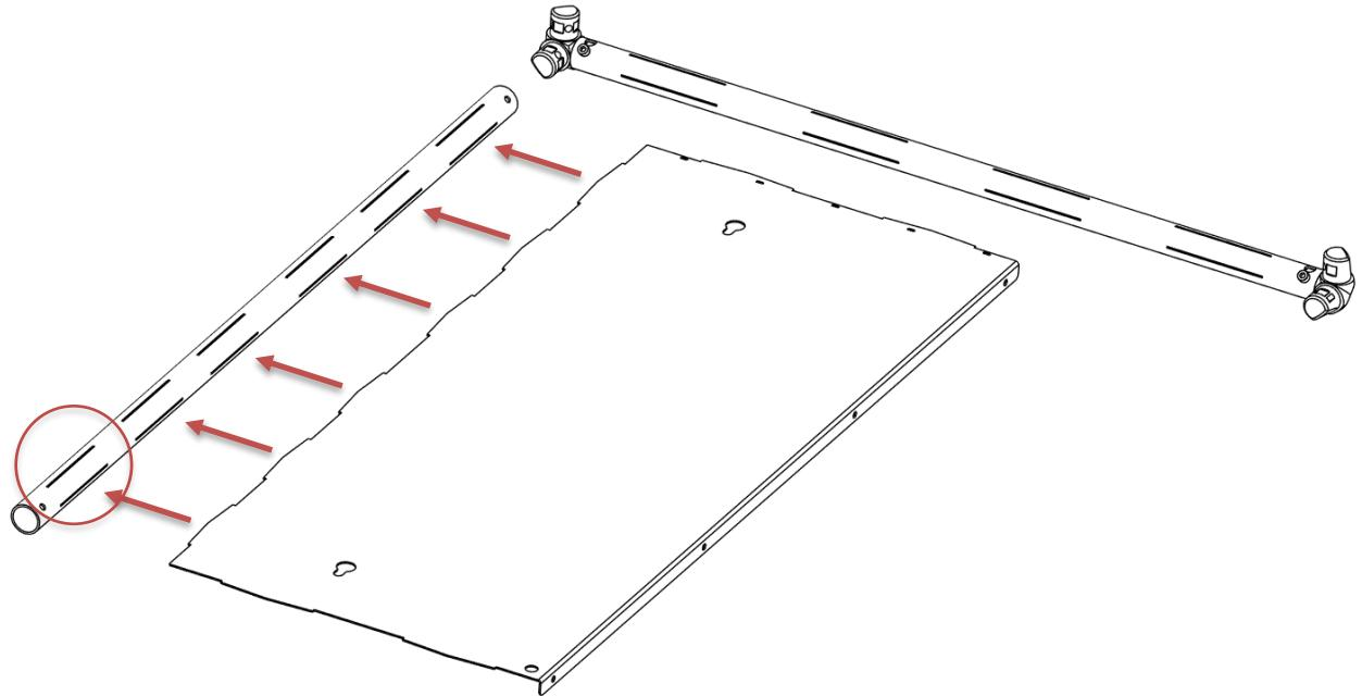
Faites maintenant glisser le long tube et la feuille d'aluminium sur le bout horizontal de la pièce d'angle gauche. En même temps, guidez les languettes de la feuille d'aluminium dans les fentes du tube de longueur moyenne.
