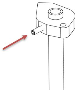
Positionnez le bloc d' entraînement de manière à ce que la vis de réglage se trouve **approximativement au centre du trou oblong**. Il s'agit de la position neutre qui fonctionnera correctement dans la plupart des cas. Vissez la vis de réglage jusqu'à ce qu'elle serre presque le bloc d' entraînement sur l' arbre à cames. L' arbre à cames doit pouvoir tourner avec une légère force manuelle. Le serrage final sera effectué lors du réglage fin de l' arbre à cames dans le dernier chapitre.
