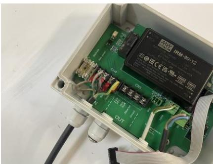
Am Slave kann ein nachfolgender FeedingMaster über ein Synchronisationskabel synchronisiert werden, das an die Klemmen des mit CN1 (Out) gekennzeichneten Steckers an der Steuerung angeschlossen wird. Befolgen Sie in diesem Fall die Anweisungen im Abschnitt „Anschluss an den Master“, um das Synchronisationskabel an den nachfolgenden FeedingMaster anzuschließen.
