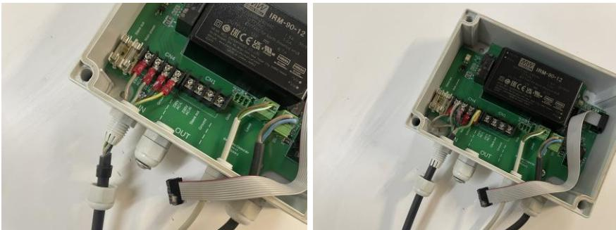
Ziehen Sie die Drähte etwas nach oben, während Sie das Synchronisationskabel in den Drehgelenk schieben. Schieben Sie es so weit, bis etwa 5 mm der schwarzen Ummantelung aus dem Drehgelenk herausragen. Ziehen Sie dann das Drehgelenk mit der Hand fest an. Überprüfen Sie, ob das Synchronisationskabel fest sitzt, indem Sie es aus dem Controller herausziehen. Es sollte nicht aus dem Drehgelenk herausrutschen.
