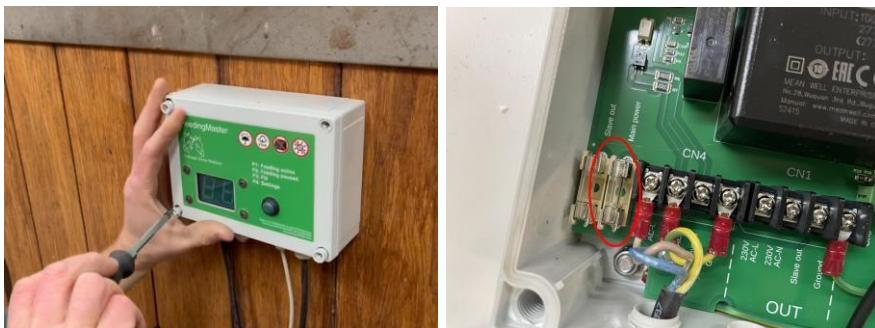
In der unteren linken Ecke der Steuerung sind zwei Sicherungen sichtbar. Die linke Sicherung dient zum Schutz des Slave-Eingangs, die rechte Sicherung ist die Hauptsicherung der Steuerung. Entfernen Sie sie, indem Sie die Sicherung aus der Halterung herausklappen. Überprüfen Sie, ob die Sicherung defekt ist. Wenn ja, ersetzen Sie sie durch eine Sicherung desselben Typs (250 VAC, 1A, träge, 5x20 mm).
