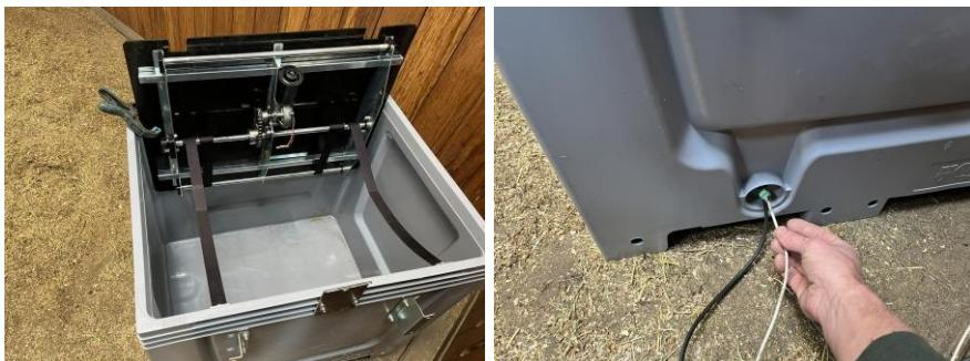
Klappen Sie die Futterbasis zu sich hin, sodass die Löcher in der Rückwand sichtbar werden. Sichern Sie sie gegebenenfalls mit einer Klemme, damit sie aufrecht bleibt. Führen Sie beide Verbindungskabel durch das Loch in der unteren rechten Ecke der Rückwand in den FeedingMaster ein.
