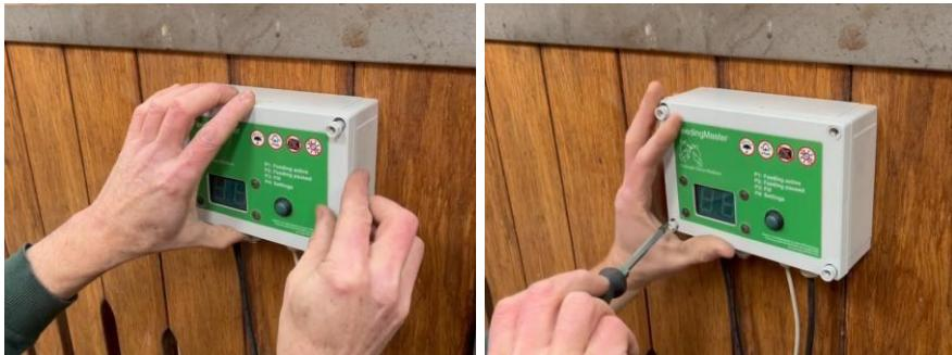
Ziehen Sie die vier grauen Schrauben an den Ecken des Steuerungsgehäuses von Hand fest. Drehen Sie sie dann um 1/8 Umdrehung im Uhrzeigersinn fest.
