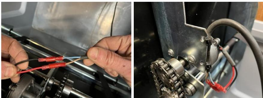
Legen Sie das schwarze Verbindungskabel gegen das Metall der Zuführbasis, es sollte vom Motor weg zeigen. Führen Sie einen Kabelbinder durch das Loch im Metall der Zuführbasis und ziehen Sie ihn fest. Führen Sie einen zweiten Kabelbinder durch das zweite Loch im Metall der Zuführbasis und ziehen Sie ihn fest. Schneiden Sie die überschüssigen Teile beider Kabelbinder ab.
