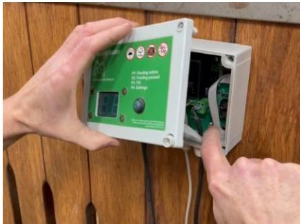
Legen Sie die Frontplatte vor den Regler. Schieben Sie das Kabel der Frontplatte in Richtung der unteren rechten Ecke des Gehäuses. Setzen Sie die Frontplatte auf den Regler. Überprüfen Sie, ob sie an allen Seiten bündig mit dem Gehäuse abschließt. Die Frontplatte muss ohne Widerstand am Gehäuse anliegen. Drücken Sie sie niemals fest, wenn dies nicht der Fall ist. Überprüfen Sie in diesem Fall, ob sich keine Kabel zwischen der Frontplatte und dem Regler befinden.
