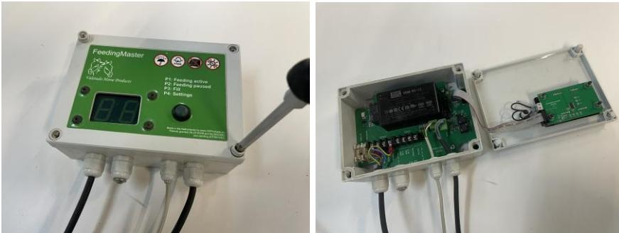
Um die Montage des Controllers zu erleichtern, kann die Frontblende vorübergehend vom Controller getrennt werden. Ziehen Sie dazu vorsichtig den schwarzen Stecker aus der Frontblende heraus.
