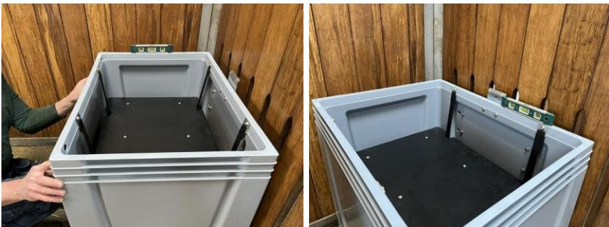
Überprüfen Sie, ob der FeedingMaster sowohl in der Tiefe als auch in der Breite waagerecht ist. Um den FeedingMaster waagerecht auszurichten, können Ausgleichsplatten unter die Beine des FeedingMasters gelegt werden, sofern diese nicht dicker als 5 mm sind.
