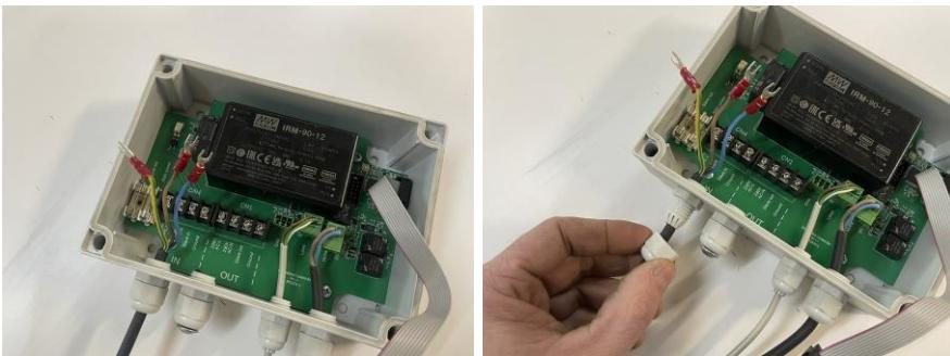
Um das Durchführen des Synchronisationskabels zu erleichtern, kann der Drehgelenk vollständig abgeschraubt werden. Schieben Sie ihn über das Synchronisationskabel. Sie können auch den schwarzen Gummiring von der Stopfbuchse entfernen, die noch im Gehäuse verschraubt ist. Schieben Sie den Gummiring ebenfalls über das Synchronisationskabel.
