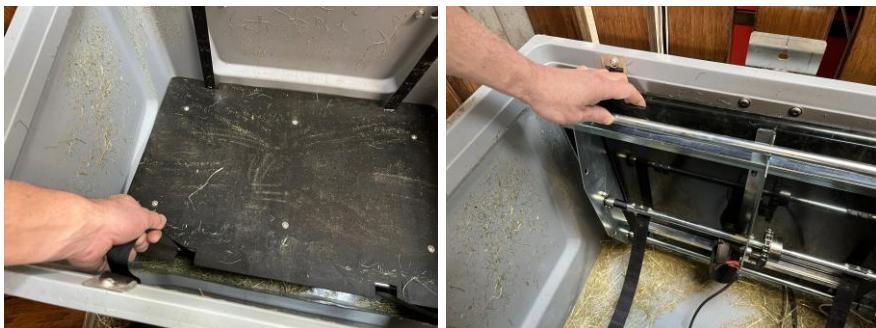
**WARNUNG:** Neigen Sie die Zuführungsbasis niemals von hinten nach vorne. Dies kann dazu führen, dass sich die Antriebskabel im Antrieb verfangen und dauerhafte Schäden verursachen.
