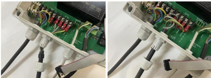
Ziehen Sie dann den Drehgelenkverschluss fest von Hand an. Überprüfen Sie, ob das Synchronisationskabel fest sitzt, indem Sie es aus dem Controller herausziehen. Es sollte nicht aus dem Drehgelenkverschluss herausrutschen.
