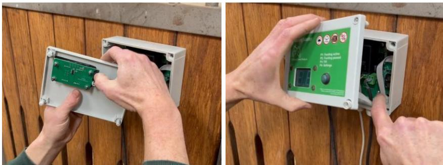
Setzen Sie die Frontplatte vor den Regler. Schieben Sie das Kabel der Frontplatte in Richtung der rechten unteren Ecke des Gehäuses. Setzen Sie die Frontplatte auf den Regler. Vergewissern Sie sich, dass sie an allen Seiten bündig mit dem Gehäuse abschließt. Die Frontplatte sollte ohne Widerstand am Gehäuse anliegen. Drücken Sie sie niemals, wenn dies nicht der Fall ist. Überprüfen Sie in diesem Fall, ob sich keine Kabel zwischen der Frontplatte und dem Regler befinden.
