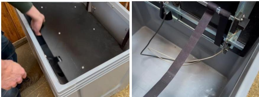
Senken Sie die Futterbasis vorsichtig wieder ab. Klappen Sie sie nun von sich weg. Überprüfen Sie, ob sich beide Verbindungskabel frei bewegen können und nicht zwischen den Aufhängungsgurten und dem Antrieb eingeklemmt sind. Beide Verbindungskabel müssen unter den vorderen Aufhängungsgurten verlaufen. Senken Sie die Futterbasis vorsichtig wieder ab.
