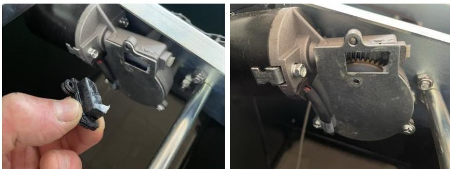
Setzen Sie die schwarze Kappe wieder auf den Motor und befestigen Sie sie mit den beiden Schrauben, wobei die längste Schraube in das obere Loch kommt. Sprühen Sie etwas weißes Fett zwischen die Achsen und die schwarzen Lagerblöcke. Drehen Sie die Drehwellen einige Male, um das Fett zu verteilen.
