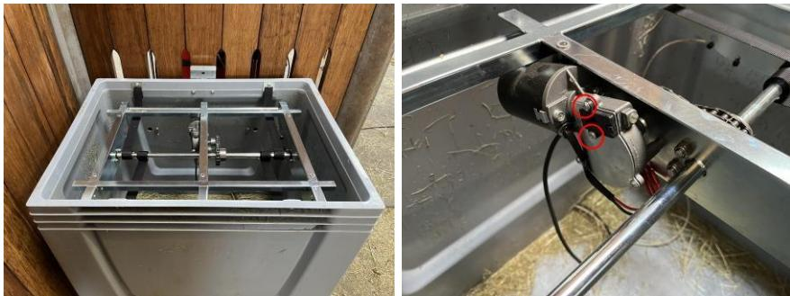
Ziehen Sie die schwarze Kappe aus dem Motor heraus, um die Zahnräder freizulegen. Wenn sich viel Fett an der Wand des Motors angesammelt hat, kann dieses mit einem feinen Schraubendreher von der Wand abgekratzt und auf die Zahnräder und zwischen die Zahnräder aufgetragen werden. Wenn kein Fett sichtbar ist, geben Sie einen Teelöffel Weißfett oder Vaseline auf die Zahnräder und zwischen die Zahnräder.
