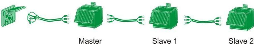
**WARNUNG:** Schließen Sie niemals mehr als 4 Slave-FeedingMaster an einen Master an. Der Master würde sonst überlastet und es bestünde Brandgefahr.
