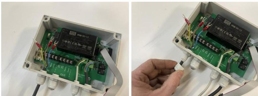
Entfernen Sie das Netzkabel, indem Sie alle drei Gabelkabelschuhe nacheinander aus dem Drehgelenk herausziehen.
