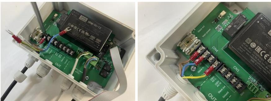
Ziehen Sie die Drähte etwas nach oben, während Sie das Netzkabel in den Drehanschluss schieben. Schieben Sie es so weit, bis etwa 5 mm der schwarzen Ummantelung aus dem Drehanschluss herausragen. Ziehen Sie dann den Drehanschluss mit der Hand fest an. Überprüfen Sie, ob das Netzkabel fest sitzt, indem Sie es aus der Steuerung herausziehen. Es sollte nicht aus der Verschraubung herausrutschen.
