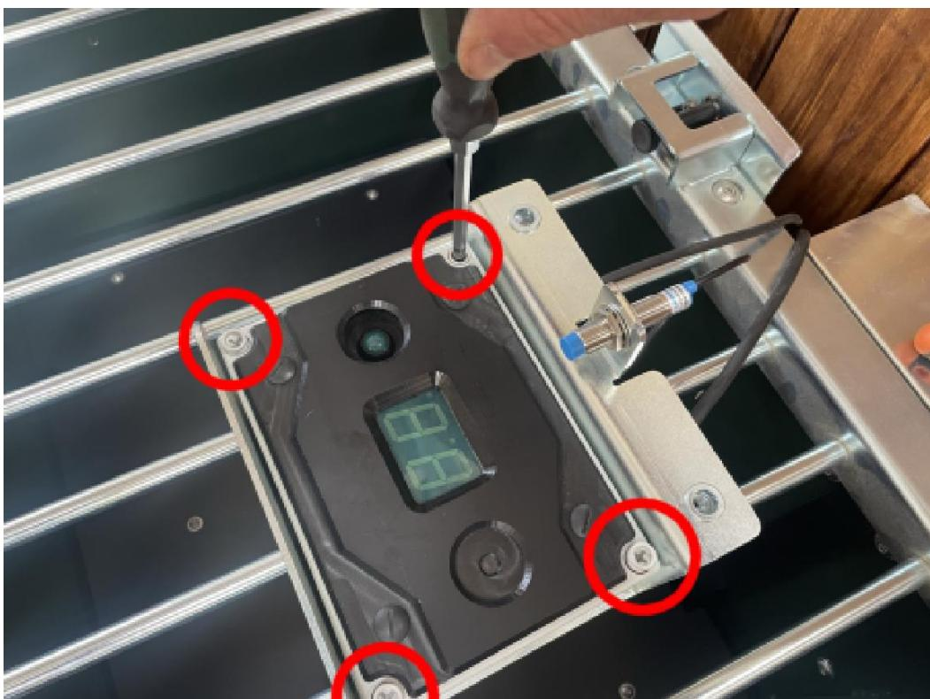
**WARNUNG:** Wenn die Muttern zu fest angezogen werden, wird die Silikondichtung zwischen der Vorder- und Rückseite des Gehäuses gequetscht und die beiden Teile sind nicht mehr wassererdicht. Dann kann sich Feuchtigkeit im Gehäuse niederschlagen und zu einer Fehlfunktion des Controllers führen.
