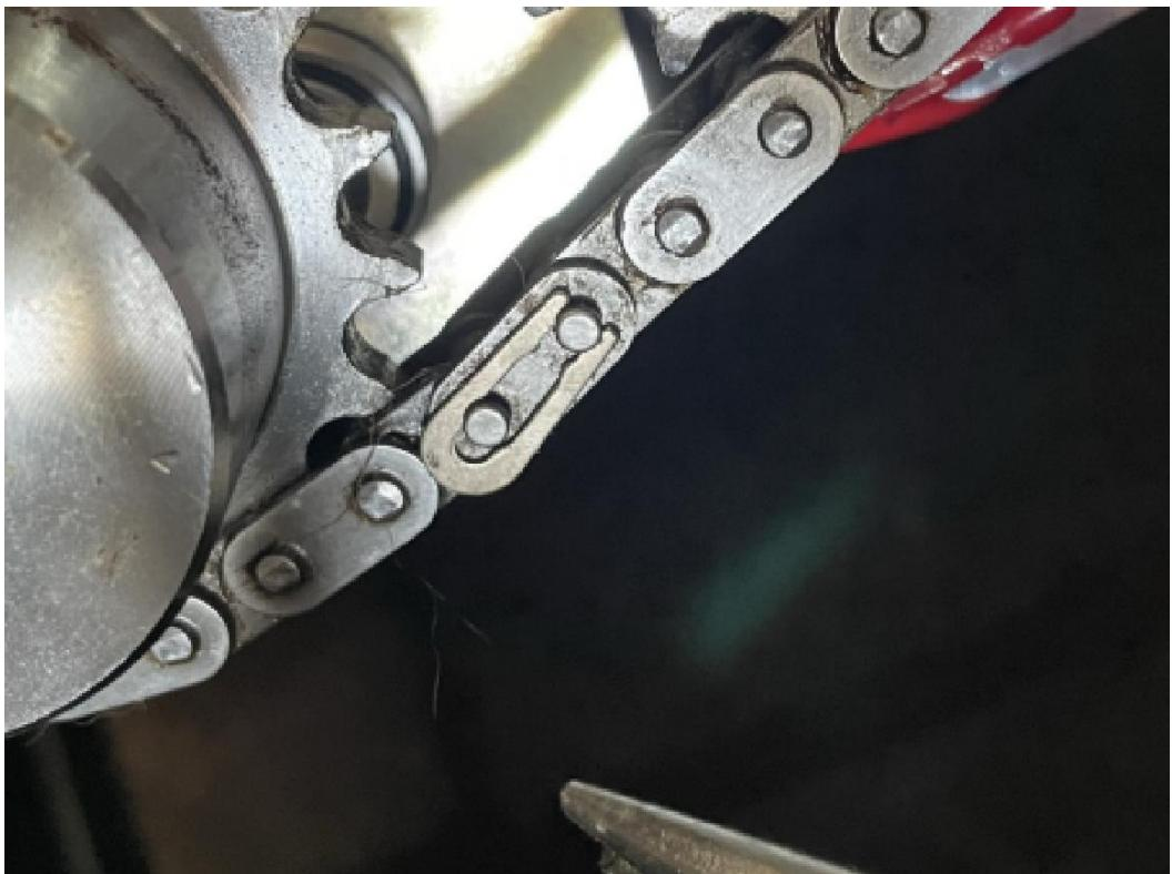
[ ] Entfernen Sie die Halteplatte vom Kupplungsteil.
