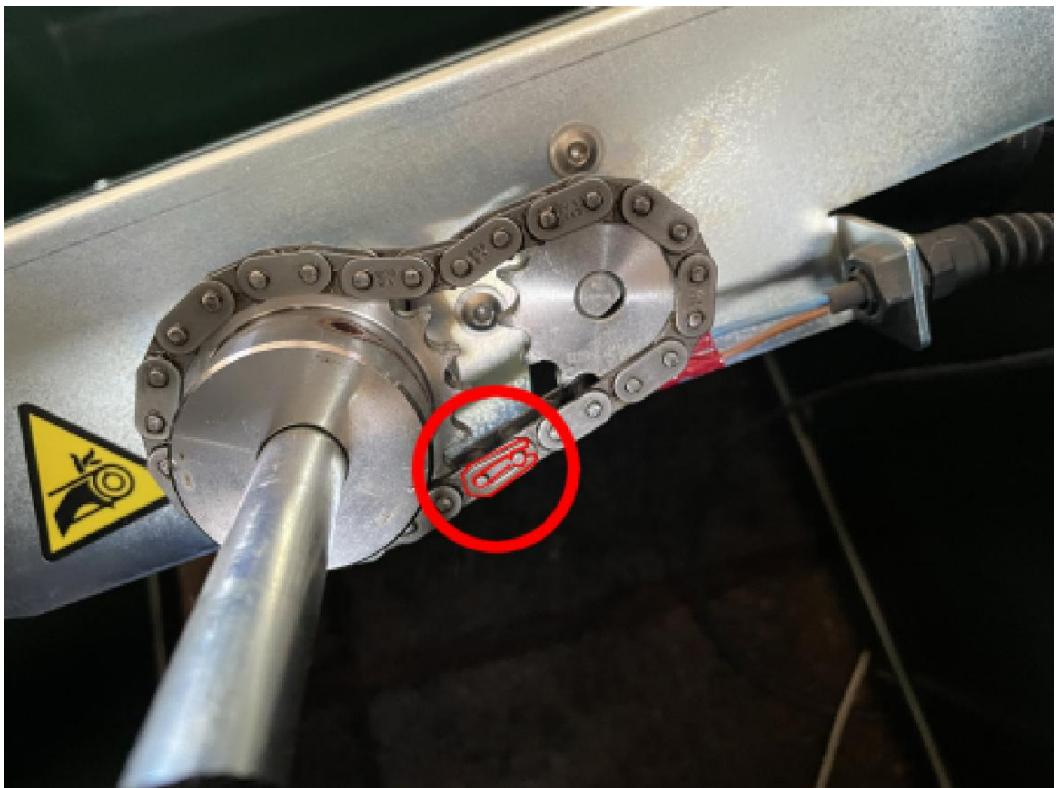
[ ] Drücken Sie den Halteclip mit einer Spitzzange nach hinten.
