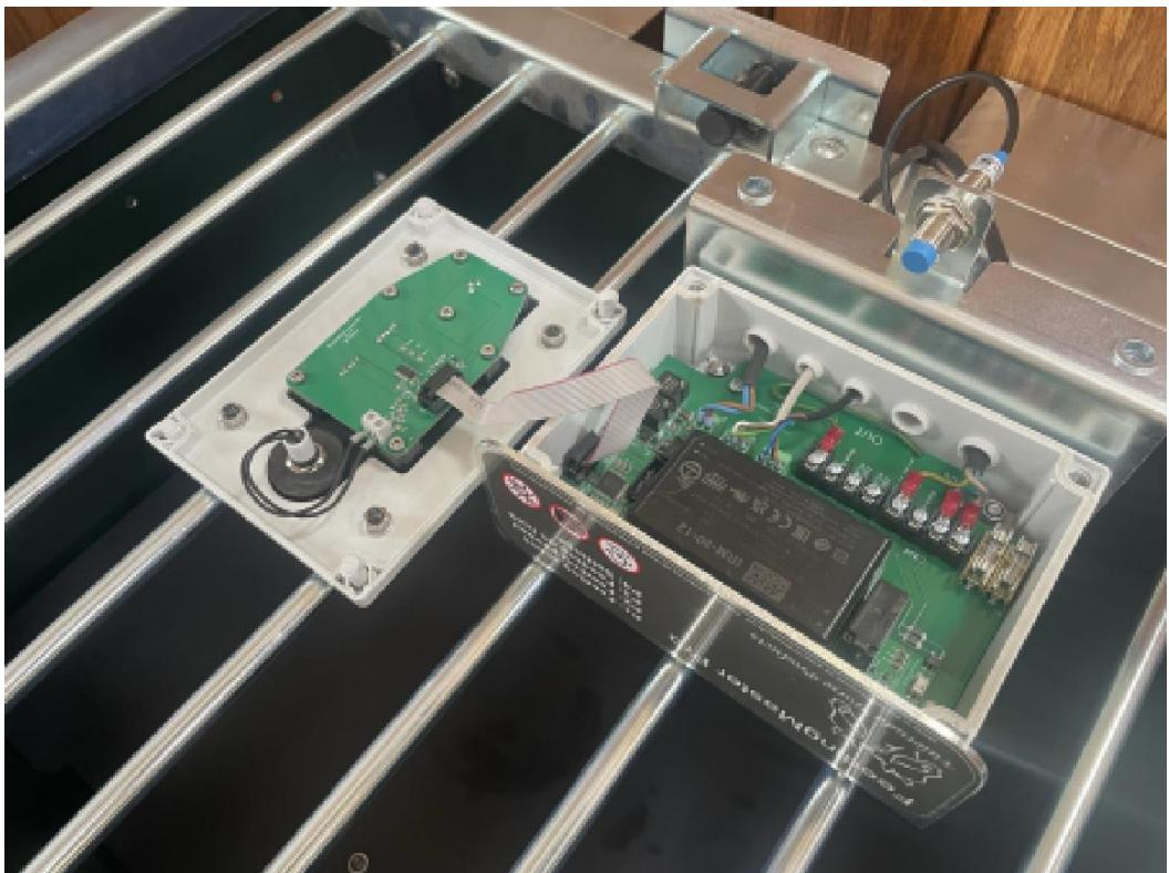
[ ] Entfernen Sie den Stecker vom Anschluss mit der Bezeichnung „Motor“.
